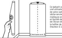
Ce gabarit vous permet une installation optimale de votre radiateur sèche-serviettes : meilleure ergonomie et facilité de lecture de l'écran digital sur le boîtier de commande (hauteur à 1,30m)
