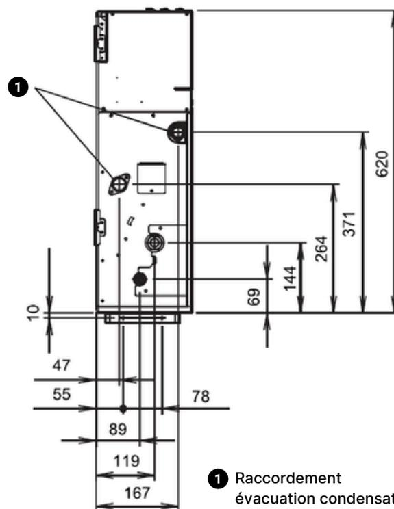
① Raccordement évacuation condensat
