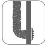
Conduit sans longueur inutile ni col de cygne
