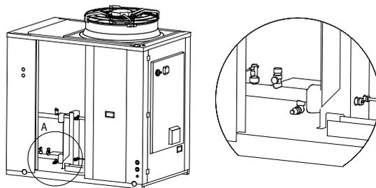
Nel caso si debba scaricare completamente l'unità, chiudere prima le saracinesche manuali di ingresso e uscita (non in dotazione) e quindi staccare i tubi predisposti esternamente su ingresso e uscita acqua in modo da far fuoriuscire il liquido contenuto nell'unità (per rendere agevole l'operazione, è consigliabile installare esternamente su ingresso e uscita acqua due rubinetti di scarico interposti tra l'unità e le saracinesche manuali).
