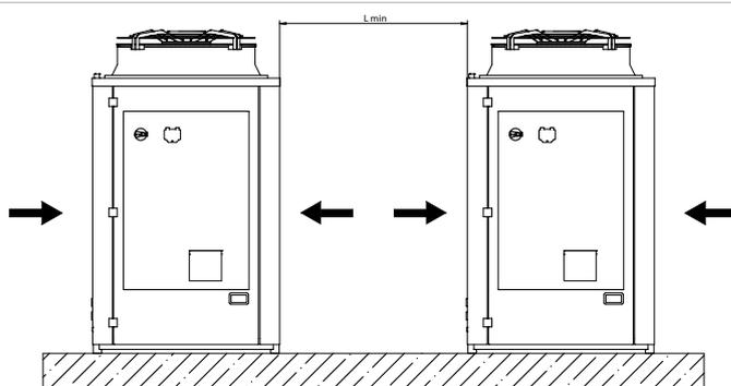
È da evitare la copertura con tettoie o il posizionamento vicino a piante o pareti onde evitare il ricircolo dell'aria.
