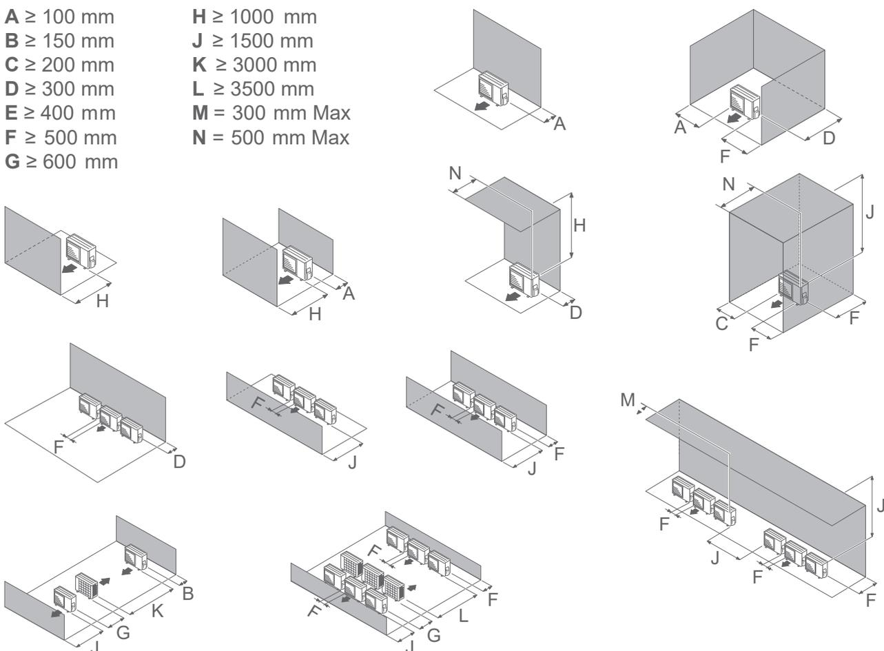
fig. 6 - Dégagements minimum d'installation autour de l'unité extérieure
