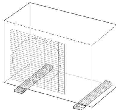
fig. 7 - Disposition de pieds en caoutchouc (option)
