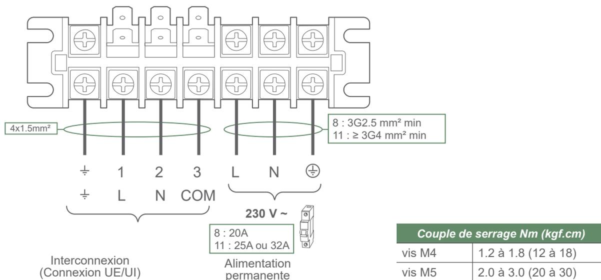
fig. 11 - Bornier de raccordement électrique coté unité extérieure
