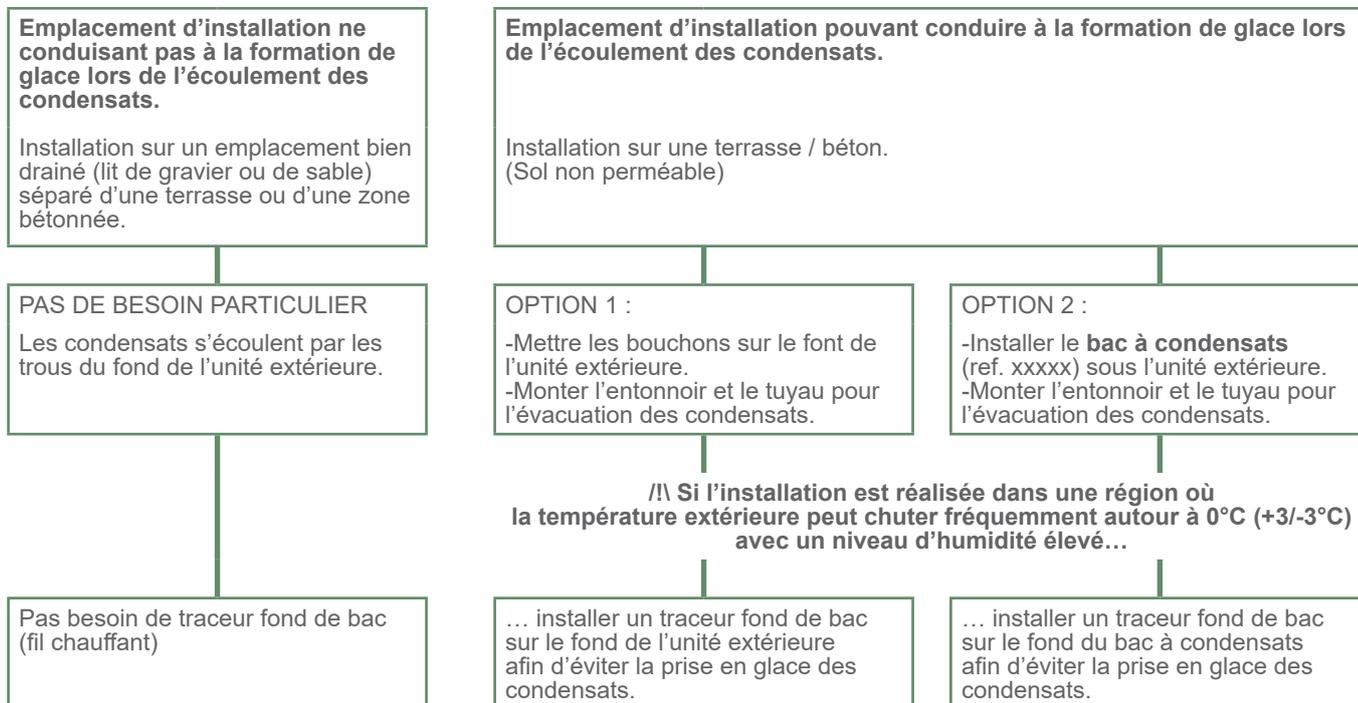
En fonctionnement de l'eau peut s'évacuer de l'unité extérieure. Ne pas installer l'appareil sur une terrasse, mais préférer un endroit drainé (lit de graviers ou sable). Si l'installation est réalisée dans une région où la température extérieure peut être chuter autour à 0 °C pendant une longue période, vérifier que la présence de glace ne présente aucun danger.
