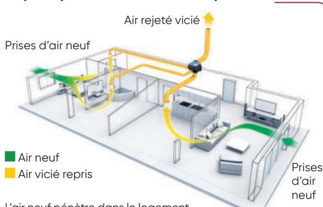
L'air neuf pénètre dans le logement par des entrées d'air placées au-dessus des fenêtres des chambres et du séjour.
