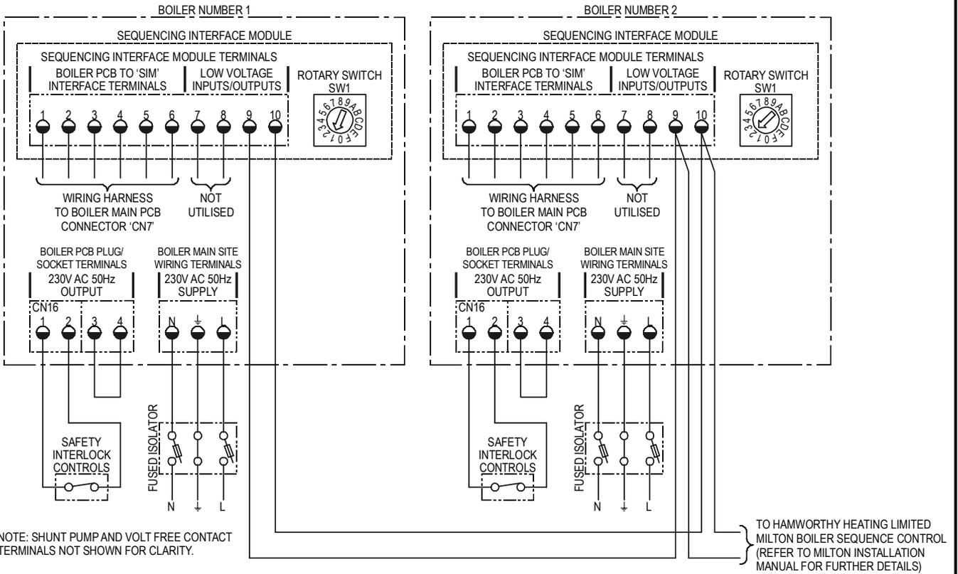
3) MULTIPLE BOILER INSTALLATION, ON/OFF OR HIGH/LOW (CLASSIC WITH FLUE HIGH/LOW FLUE DAMPER MODELS ONLY) OPERATION VIA NON HAMWORTHY HEATING LIMITED BOILER SEQUENCE CONTROL.
