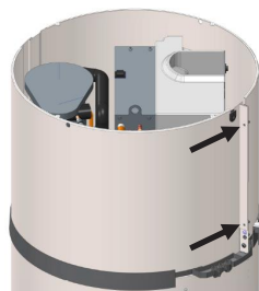
Svitare le 2 viti del coperchio anteriore
