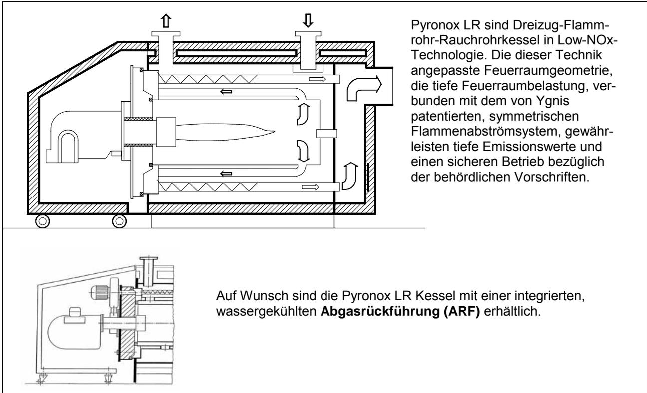
Der 3. Kesselzug ist mit Turbulatoren bestückt. Ihre turbulenz erzeugende Wirkung erhöht zusätzlich den Wärmeübergang, ermöglicht Betriebsweisen mit tiefen Abgastemperaturen und gewährleistet eine optimale Brennstoffnutzung.
