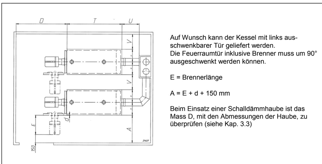
Auf Wunsch kann der Kessel mit links ausschwenkbarer Tür geliefert werden. Die Feuerraumtür inklusive Brenner muss um 90° ausgeschwenkt werden können.
