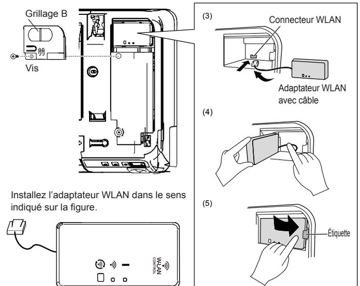
Installez l'adaptateur WLAN dans le sens indiqué sur la figure.
