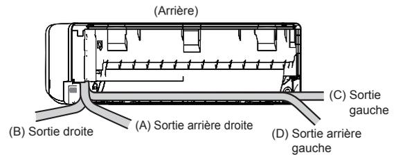
Exemple : Dans le cas d'une sortie droite (Bien que la figure dans le cas d'une sortie gauche soit omise, il en va de même.)
