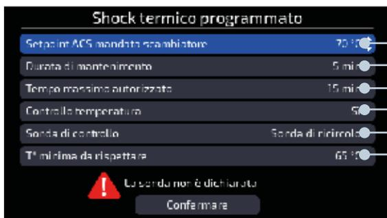
**Esempio 1** : shock termico senza controllo della temperatura di ritorno sanitaria
