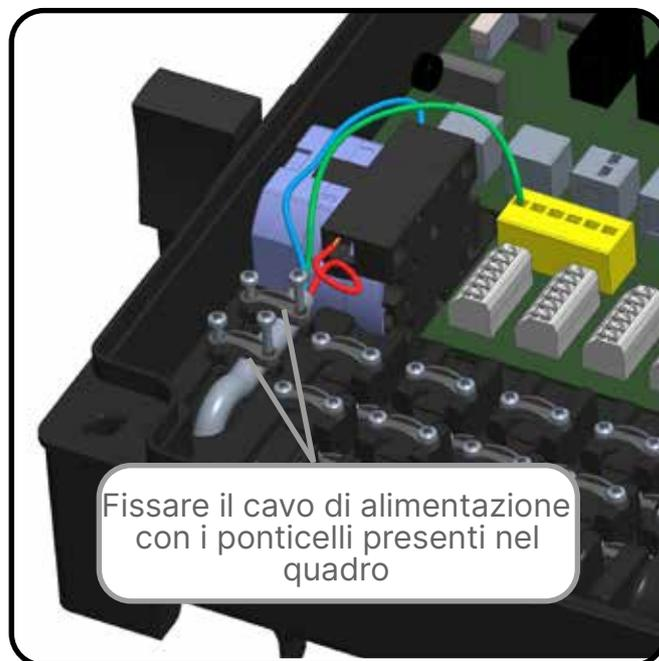
Fissare il cavo di alimentazione con i ponticelli presenti nel quadro
