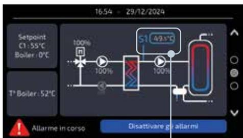
Visualizzazione della sonda in blu: buono stato di funzionamento
