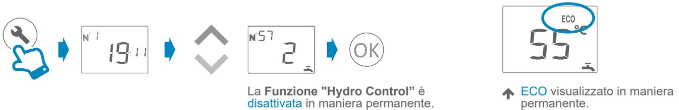
La Funzione "Hydro Control" è **disattivata** in maniera permanente.
