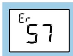
Pressione idraulica inferiore a 0,4 bar:
