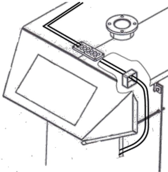
Les câbles et les conduites électriques doivent être posés et protégés comme sur l'illustration ci-dessus. Pour soulager la tension, les câbles doivent être fixés sur la tige filetée de la visière de la chaudière à l'aide de colliers de câblage. Les câbles de réseau et de très faible tension (conduites des sondes, conduites bus etc.) doivent être posés séparément. Il ne faut pas enrouler de longues boucles de câble superflues à l'intérieur du carénage de la chaudière.
