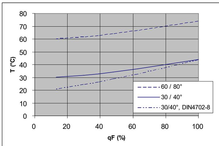
Température des fumées d'un VARINO GRANDE en fonction de la charge
