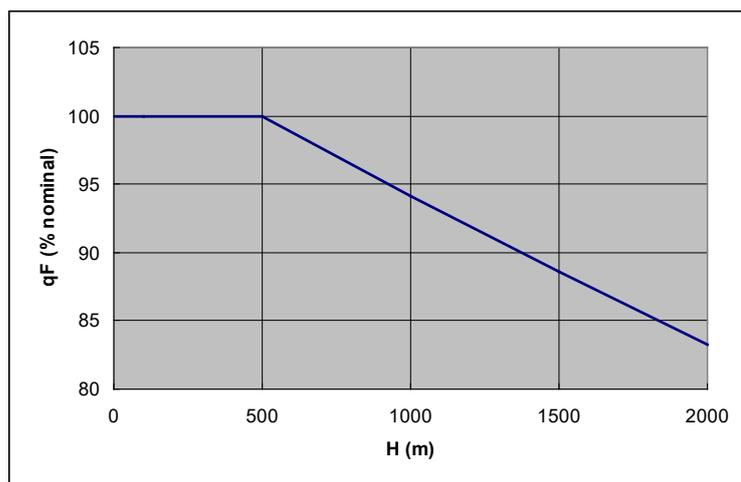
La correction réelle peut être plus faible, une marge a été prise en compte pour les variations barométriques.
