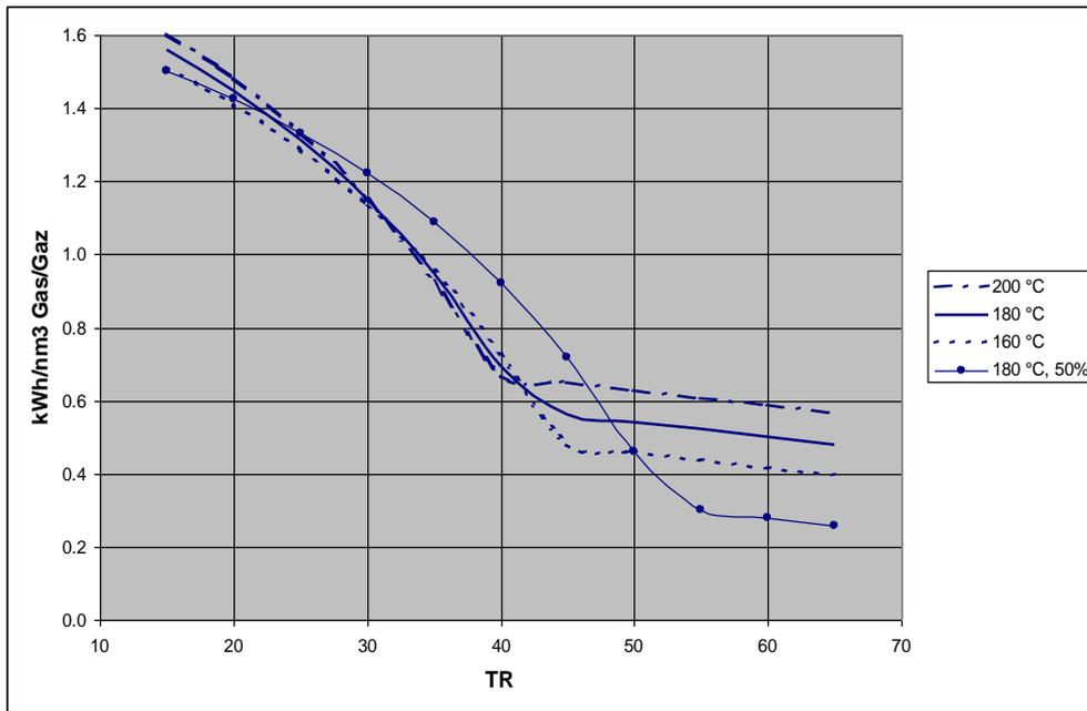
Potencia del calentador por nm3 de gas para temperaturas de entrada de los humos diferentes y temperaturas de retorno de calentador TR a cargas de caldera nominales así como 50% (para temperatura de entrada nominal de 180°C)
