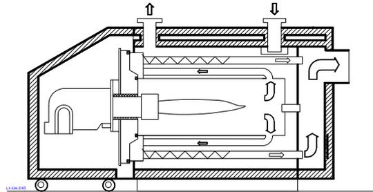
El tercer paso de la caldera está dotado de turbuladores. Su acción turbulenta aumenta ulteriormente el paso del calor y permite un funcionamiento con bajas temperaturas de los gases de combustión, garantizando así un aprovechamiento óptimo del combustible.
