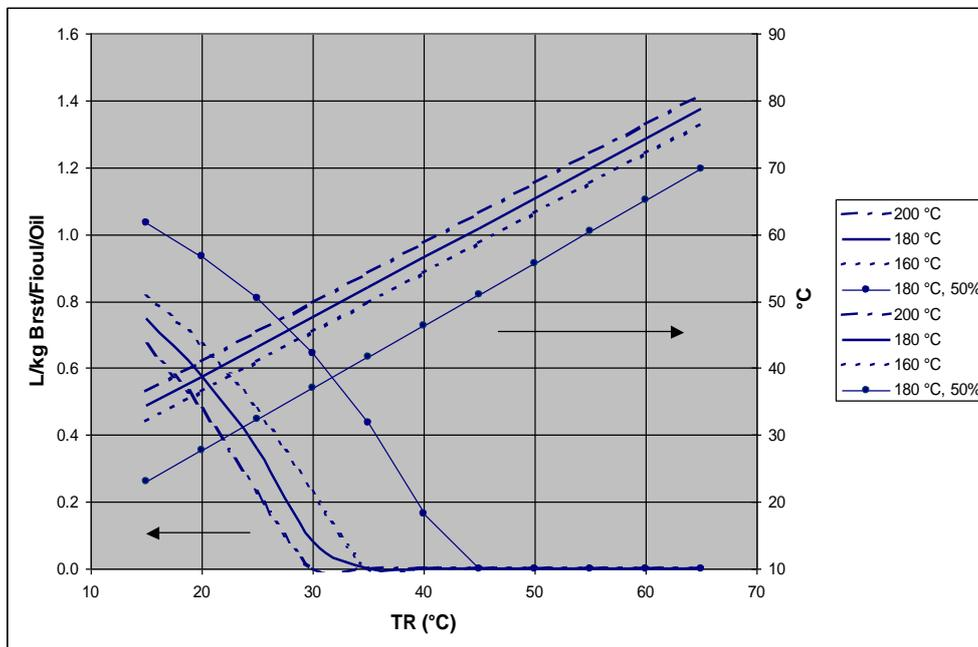
Cantidad de agua de condensación por kg de gasóleo para temperaturas de entrada de los humos diferentes y temperaturas de retorno de calentador TR a cargas de caldera nominales así como 50% (para temperatura de entrada nominal de 180°C)
