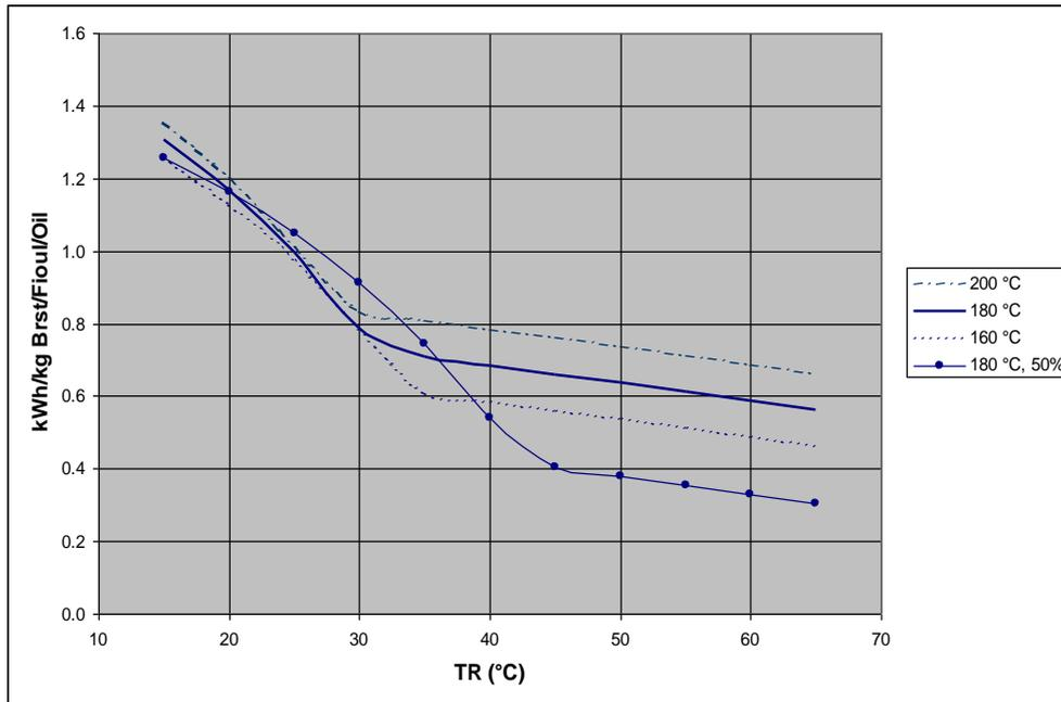
Potencia del calentador por kg de gasóleo para temperaturas de entrada de los humos diferentes y temperaturas de retorno de calentador TR a cargas de caldera nominales así como 50% (para temperatura de entrada nominal de 180°C)
