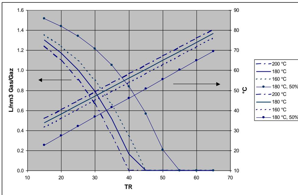
Cantidad de agua de condensación por nm3 de gas para temperaturas de entrada de los humos diferentes y temperaturas de retorno de calentador TR a cargas de caldera nominales así como 50% (para temperatura de entrada nominal de 180°C)
