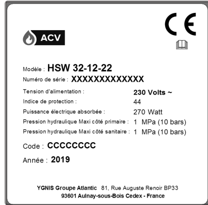
figure 1 - Placa de señalización
