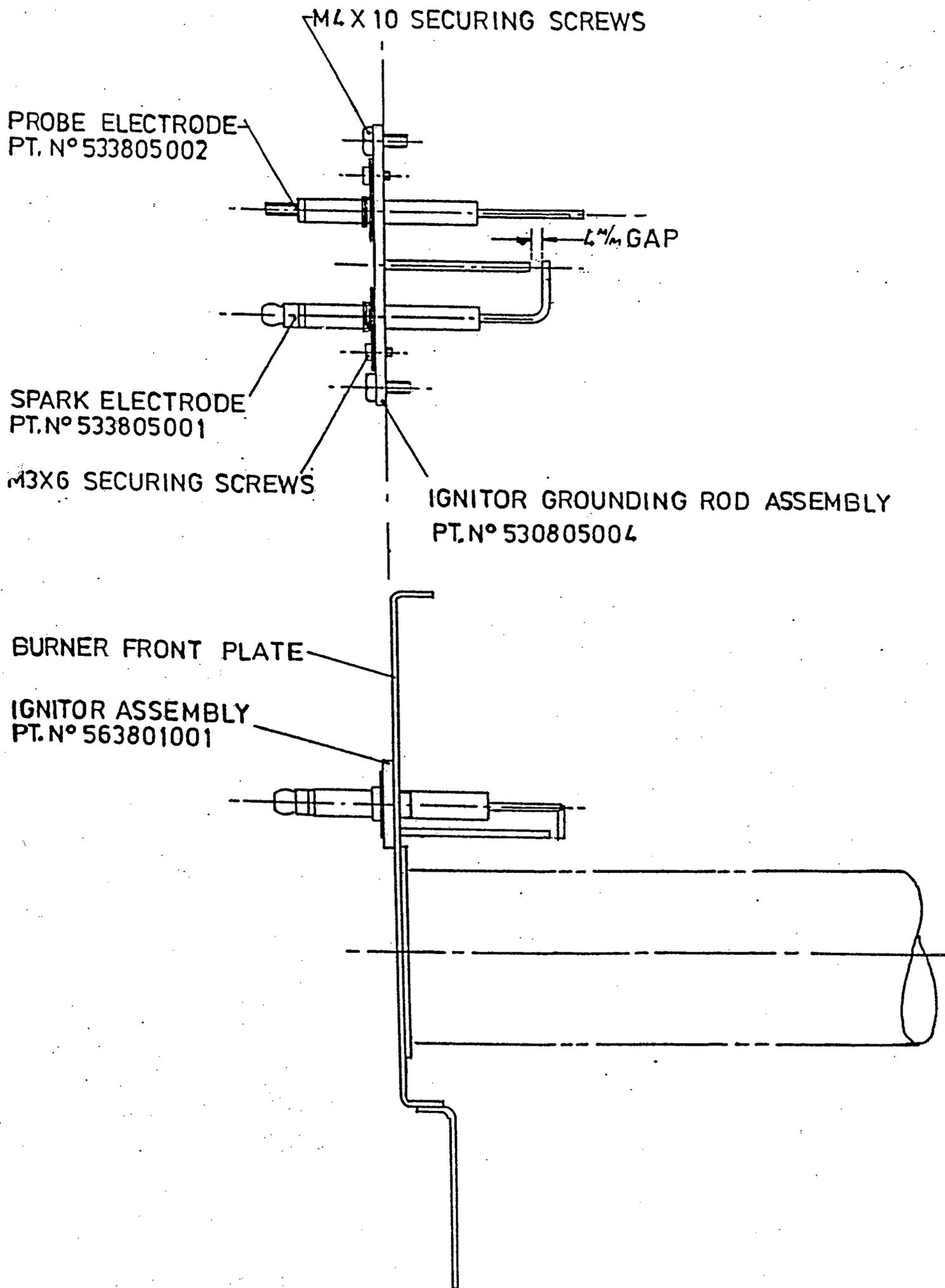
FULLY AUTOMATIC BURNER IGNITOR ARRANGEMENT
