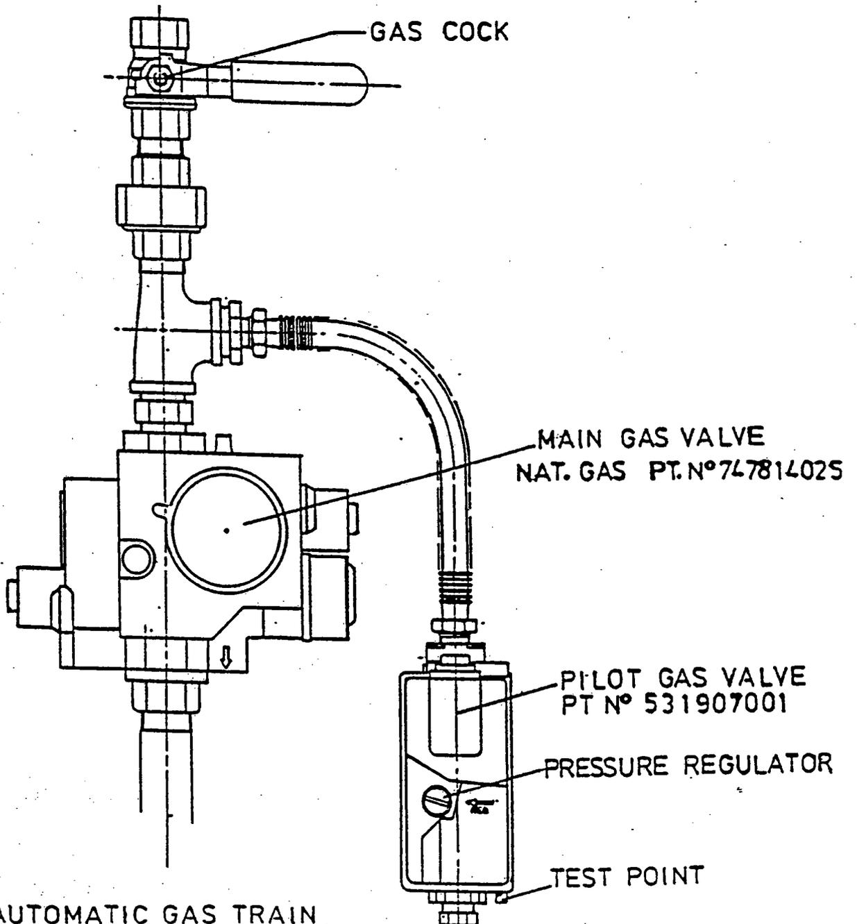
**AUTOMATIC GAS TRAIN WITH HONEYWELL VR4900C AND VR4705A GAS CONTROL VALVES**
