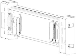
**4** Positionnez le radiateur dans ses 2 cales, sur le côté opposé au boîtier.
