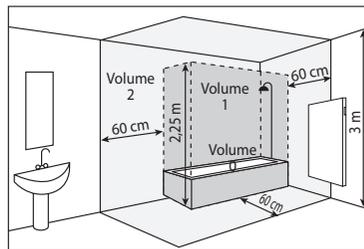
Les appareils utilisés dans les salles de bains doivent être installés de façon telle que les interrupteurs et autres dispositifs de commande de l'appareil ne puissent être touchés par une personne dans la baignoire ou la douche.
