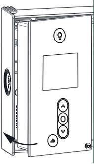
**11** Repositionnez la partie avant dans la partie arrière du boîtier de commande.
