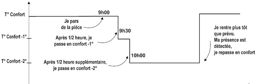
L'activation de la fonction détection d'occupation dans le Mode Prog, permet de gérer vos présences imprévues automatiquement.
