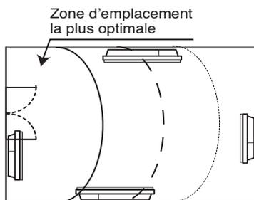
La fonction Fenêtre Ouverte/Fenêtre fermée est déconseillée dans les couloirs et dans les pièces situées à proximité d'une porte d'entrée donnant sur l'extérieur. Choisir l'emplacement le plus optimal.
