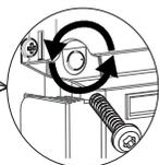
❶ Retirez et conservez les 4 vis de fixation situées à l'arrière du support du boîtier de commande.
