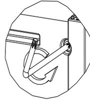
**7** Retirez et conservez les deux vis de fixation de la partie arrière du boîtier de commande.
