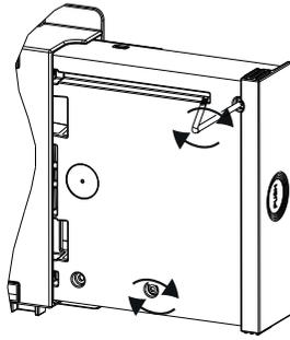
**12** Remettez en place les deux vis de fixation de la partie arrière du boîtier de commande.
