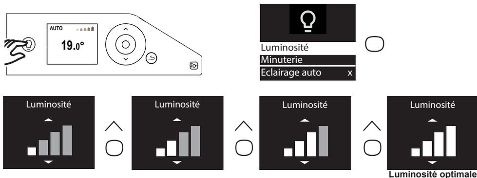
Le menu «Luminosité» permet de régler l'intensité lumineuse diffusée par l'appareil, sur 4 niveaux.
