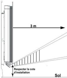
La détection se fait au dessus du capteur.
