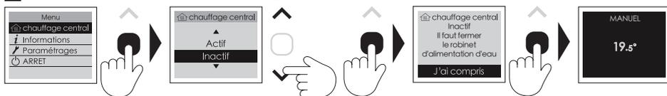
En mode chauffage central inactif, le mode par défaut est la programmation avec une température de confort de 19°C.
