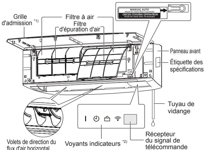
\*1) Avant de démarrer l'appareil, vérifiez que la grille d'admission est complètement fermée. Une fermeture incomplète risque d'affecter le bon fonctionnement ou les performances de l'appareil.
