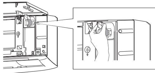
4. Branchez l'adaptateur W-LAN dans la fente de connexion de l'unité intérieure dans le sens indiqué sur la figure.
