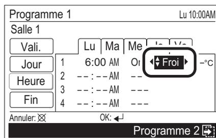
Une fois le « Mode de fonctionnement » réglé, passez à la « Température » en appuyant sur les touches fléchées (droite).
