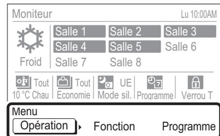
Il s'agit du menu qui permet de régler le fonctionnement ou chaque fonction. Sélectionnez le paramètre à l'aide des touches fléchées (gauche/droite) et appuyez sur la touche [Entrée] ; l'écran de fonctionnement de chaque menu apparaît.
