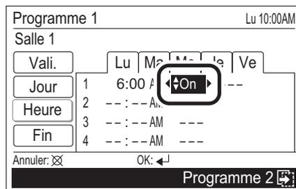
Une fois « On » réglé, passez au « Mode de fonctionnement » en appuyant sur les touches fléchées (droite).
