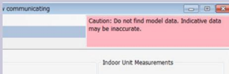
Si le message d'alerte ci-dessus s'affiche dans le coin supérieur droit de la fenêtre, le modèle cible n'est pas pris en charge. Bien que la communication et la lecture des données soient disponibles, les données risquent de ne pas être correctes.
