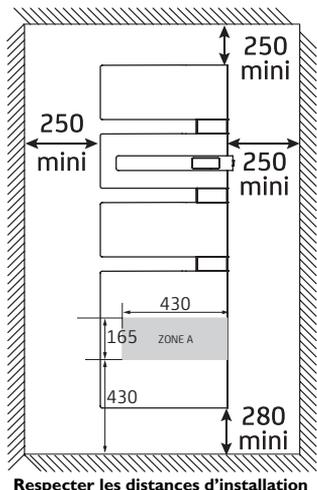
Respectez les distances minimales avec le mobilier pour l'emplacement de l'appareil.
