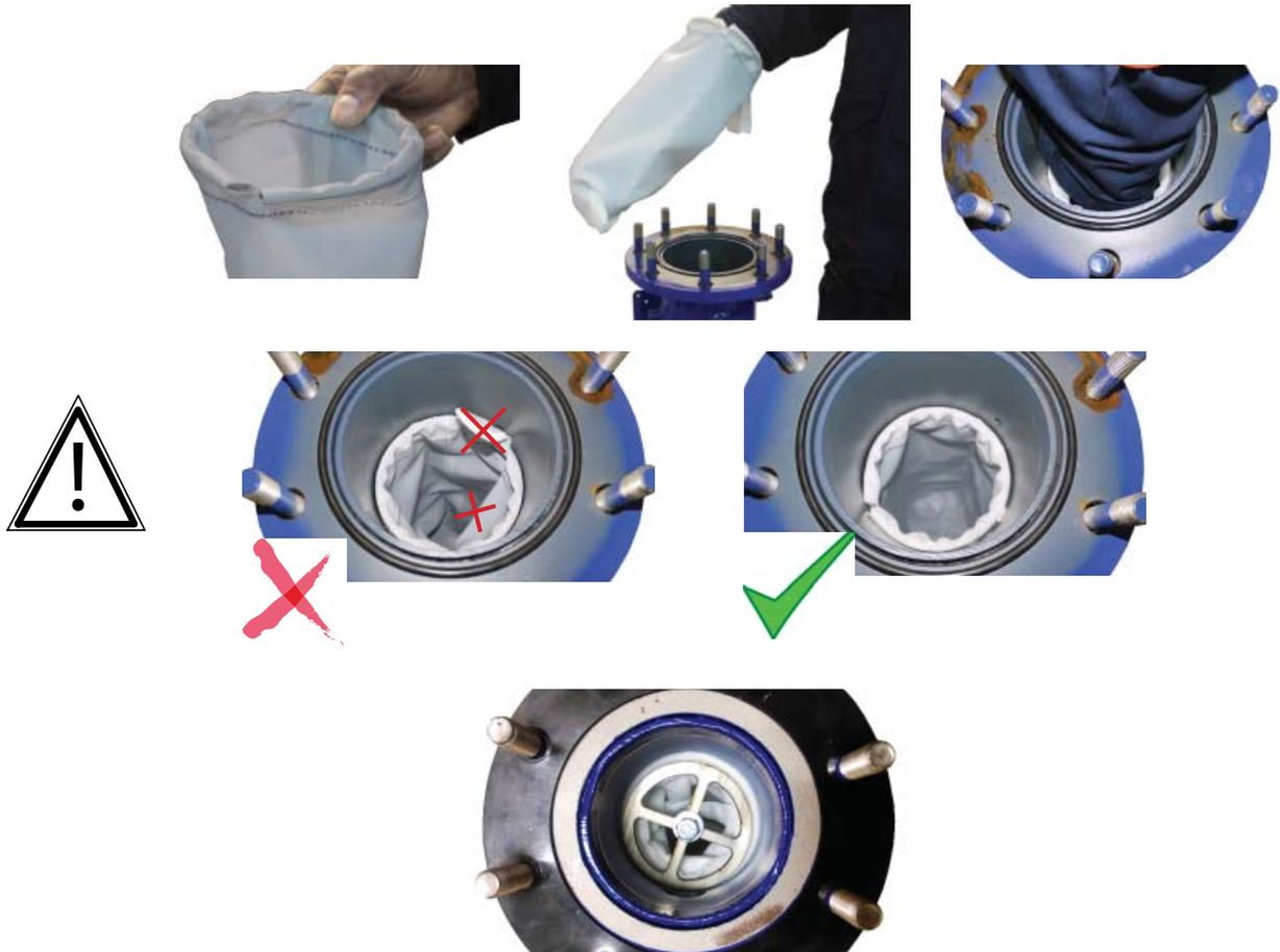
**Introducir la barra magnética con cuidado para no rasgar la bolsa por el roce de las paredes con el anillo inferior.**
