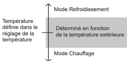
Lorsque le mode Auto est sélectionné pour la première fois, le ventilateur fonctionnera à faible vitesse pendant quelques minutes, jusqu'à ce que l'unité intérieure détecte les conditions ambiantes et sélectionne le mode de fonctionnement.
