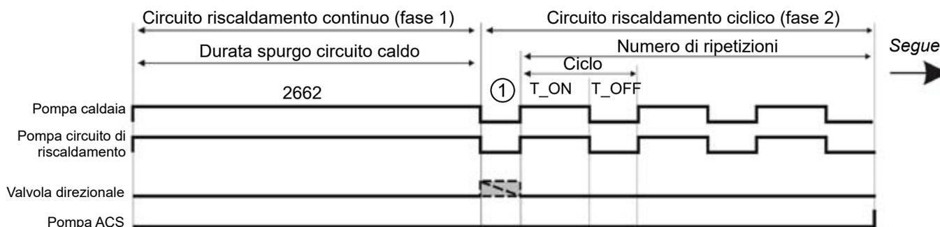
① Tempo di apertura della valvola miscelatrice riscaldamento / valvola a 3 vie
