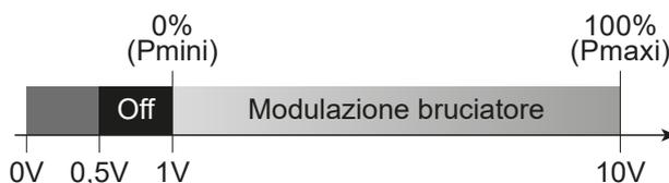
Il calcolo della modulazione del bruciatore generata viene effettuata in base alle velocità minima e massima OEM del ventilatore (setpoint minimo: parametro 9525 / setpoint massimo: parametro 9530).
