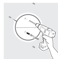
Zastosowanie stojaka jest konieczne w przypadku ściany, która nie ma odpowiednich parametrów, aby umożliwić montaż urządzenia (nie jest w stanie wytrzymać obciążenia w postaci napełnionego zasobnika). W tym przypadku, mocowanie nagrzewnicy wodnej do ściany jest obowiązkowe, albo z górnym wspornikiem, albo z wspornikiem mocującym (co umożliwia integrację w szafie o wymiarach wewnętrznych na 600 x 600 mm).
