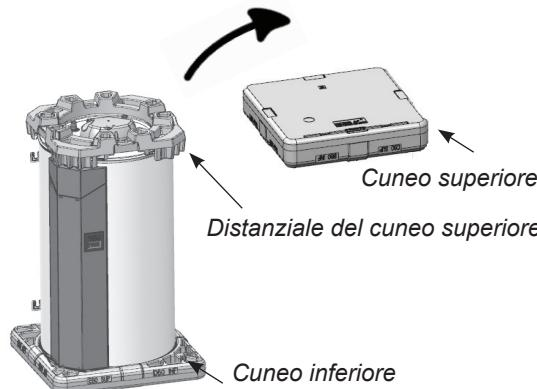
Il cuneo superiore dello scaldacqua verticale a muro è diviso in 2 parti: il distanziale consente di proteggere le prese e la copertura inferiore, una volta capovolto lo scaldacqua
