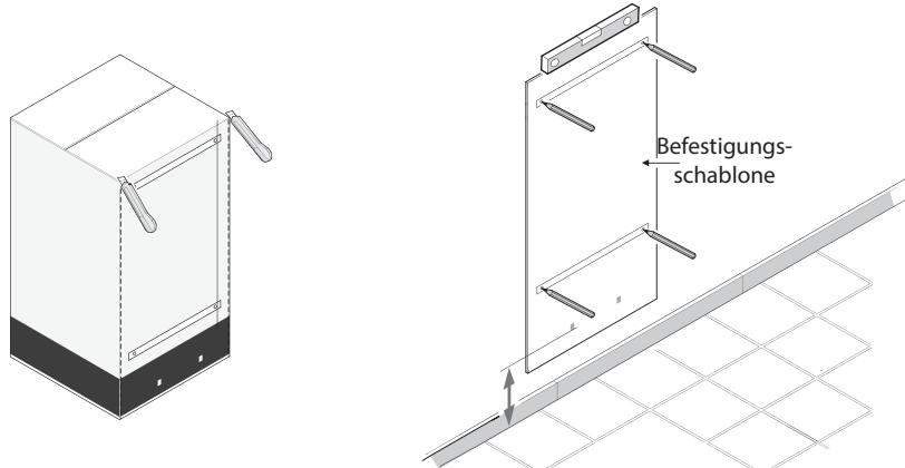
Den Warmwasserbereiter bohren und dübeln und Befestigungen mit dem Durchmesser ( $\varnothing$ ) von mindestens 10 mm passend für Ihre Wand (Gipsplatte, Beton, Ziegelstein) verwenden.
