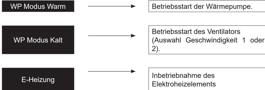
Im Testmodus, PAC-Hot-Modus, startet die Wärmepumpe, 3 Minuten nach dem Einschalten, nur wenn die folgenden Bedingungen erfüllt sind:
