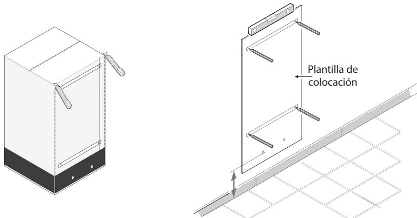
Taladra y luego clavar su calentador de agua utilizando las fijaciones de diámetro ( $\varnothing$ ) 10 mm mínimo adaptadas a su pared (placa de yeso, hormigón, ladrillo).
