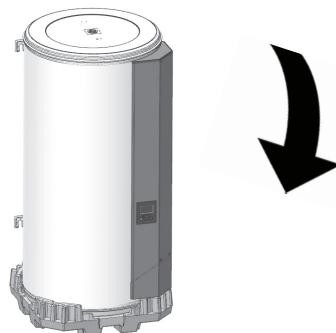
Zodra de boiler op de installatieplaats is gebracht, kan hij worden omgedraaid.
