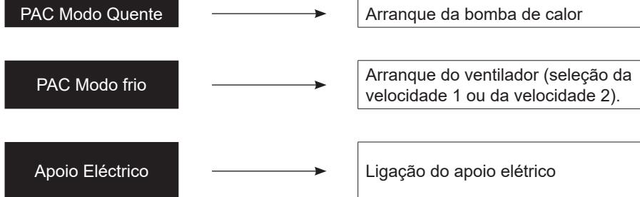
No modo de teste, o modo quente PAC, a bomba de calor começa, 3 minutos após o Power-up, apenas se as seguintes condições forem atendidas :
