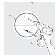
È obbligatorio utilizzare un treppiedi se si tratta di un muro non portante (che non riesce a sopportare il peso del serbatoio pieno). In questo caso è obbligatoria una fissazione del boiler alla parete, sia con la staffa superiore che con la staffa di montaggio (che permette l'integrazione in un armadio di dimensioni interne a 600 x 600 mm).
