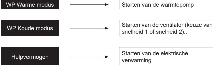
In de testmodus, PAC Hot mode, de warmtepomp begint, 3 minuten na het opstarten, alleen als aan de volgende voorwaarden is voldaan:
