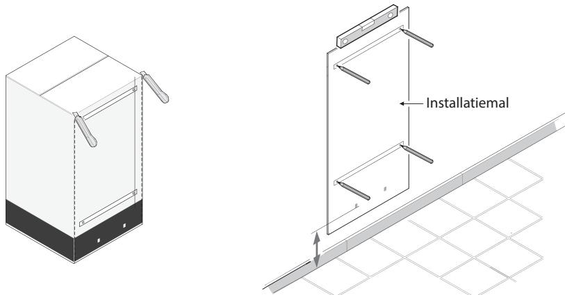
Boor gaten en breng pluggen aan (minimum Ø10 mm) die geschikt zijn voor uw muur (gipsplaten, beton, baksteen).
