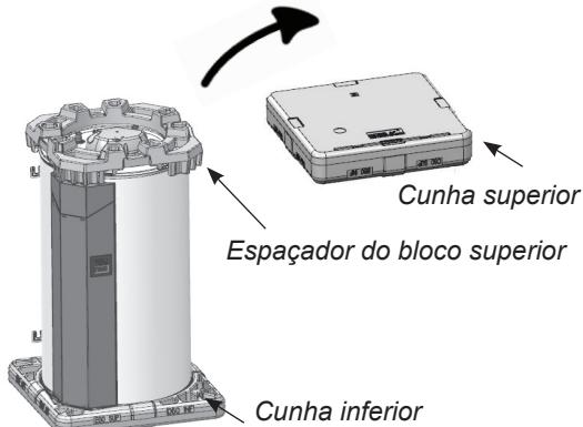
A cunha superior da bomba de calor vertical de parede separa-se em 2 partes: o espaçador que permite, depois da bomba de calor ser virada, proteger as entradas e a tampa inferior.
