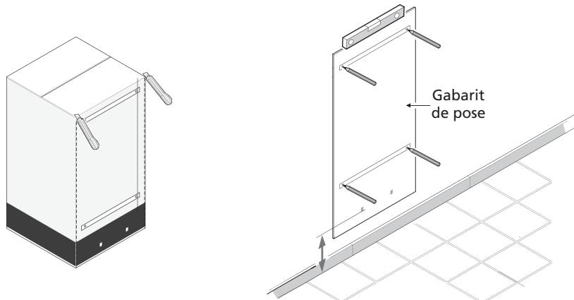
Percer puis cheviller votre chauffe-eau en utilisant des fixations de diamètre ( $\varnothing$ ) 10 mm minimum adaptées à votre mur (plaque de plâtre, béton, brique).
