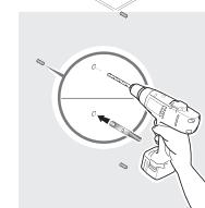
Die Benutzung eines Ständers ist zwingend erforderlich, wenn es sich um eine nicht tragende Wand handelt (die das Gewicht des gefüllten Kessels nicht stützen kann). In diesem Fall ist eine Befestigung des Wasserbereiters an der Wand obligatorisch, entweder mit der oberen Halterung oder mit der Halterung (die die Integration in einen Schrank mit Innenmaßen bei 600 x 600 mm ermöglicht).
