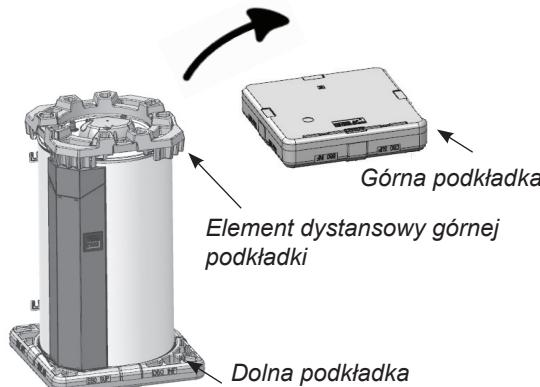
Górna podkładka pionowego, naściennego ogrzewacza wody jest podzielona na 2 części: element dystansowy umożliwia, po odwróceniu ogrzewacza, zabezpieczenie króćców i dolnej pokrywy.
