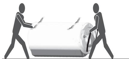
A bomba de calor vertical de parede também pode ser colocado com as cintas de transporte e os estribos. O espaçador deve ser removido para este passo.
