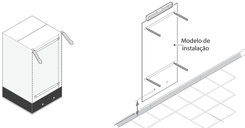
Faça os furos e, em seguida, fixe a bomba de calor utilizando as fixações com um diâmetro ( $\varnothing$ ) mínimo de 10 mm adaptadas à sua parede (placa de gesso, betão, tijolo).
