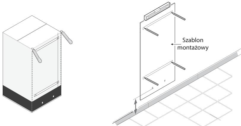
Nawiercić otwory, a następnie zamocować ogrzewacz wody przy użyciu kołków o średnicy minimalnej ( $\varnothing$ ) 10 mm, dostosowanych do typu ściany (płyta kartonowo-gipsowa, beton, cegła).
