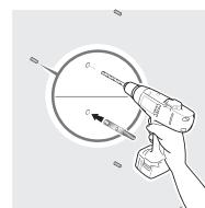
É obrigatório utilizar um tripé, no caso de uma parede sem sustentação de carga (incapaz de suportar o peso do acumulador cheio). Neste caso, uma fixação do aquecedor de água para a parede é obrigatória, quer com o suporte superior ou com o suporte de montagem (que permite a integração em um armário de dimensões internas em 600 x 600 mm).
