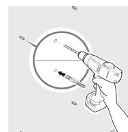
Es obligatorio el uso de un trípode si se trata de una pared que no es de carga (que no puede soportar el peso del cilindro lleno). En este caso, una fijación del calentador de agua a la pared se requiere con el soporte superior o con el soporte (lo que permite una integración en un armario de dimensiones internas a 600 x 600 mm).
