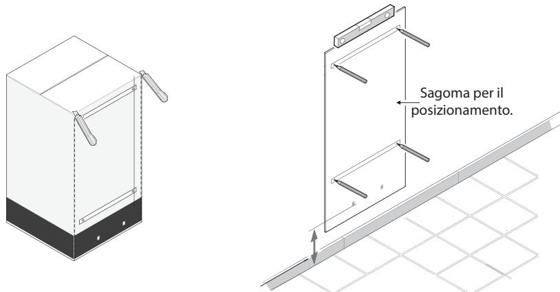
Forare e assemblare lo scaldacqua utilizzando fissaggi del diametro di ( $\varnothing$ ) 10 mm min., adattati al muro (pannello di cartongesso, cemento, mattone)..
