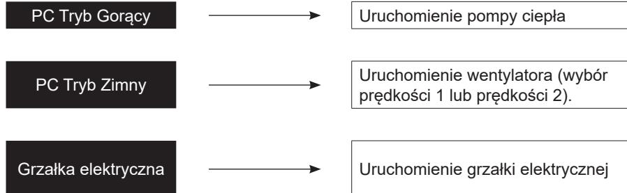
W trybie testowym tryb Hot PAC, pompa ciepła uruchamia się, 3 minuty po uruchomieniu, tylko wtedy, gdy spełnione są następujące warunki:
