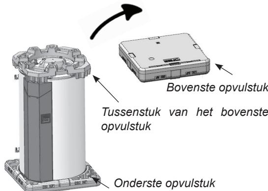
Het bovenste opvulstuk van de wandboiler bestaat uit 2 delen: het tussenstuk beschermt de aansluitingen en de onderste behuizing wanneer de boiler wordt omgedraaid.
