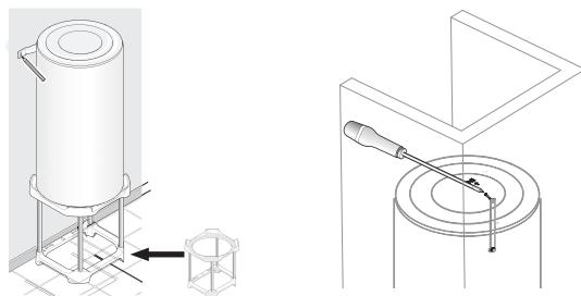
**Fijar el soporte de montaje superior.**
