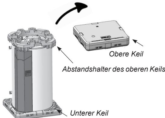
Der obere Keil des Hängespeichers besteht aus 2 Teilen: der Abstandshalter ermöglicht es, wenn der Warmwasserbereiter erst einmal umgedreht ist, die Anschlüsse und die untere Abdeckung zu schützen.
