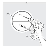
Een stander is verplicht in het geval van een niet-dragende muur (die het gewicht van een volle boiler niet kan dragen). In dit geval, een bevestiging van de boiler aan de muur is verplicht, hetzij met de bovenste beugel of met de bevestigingsbeugel (die het mogelijk maakt de integratie in een kast van interne afmetingen op 600 x 600 mm).
