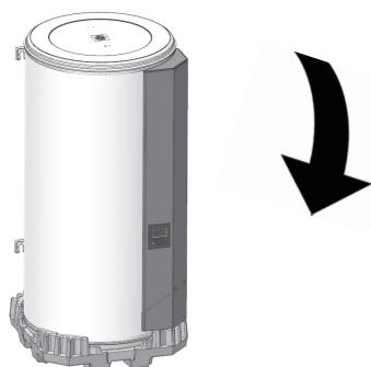
A bomba de calor pode ser virada, quando estiver próxima do respetivo local de fixação.
