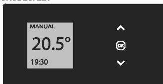
A hőmérséklet növekedése és csökkenése ( $7^{\circ}\text{C}$  és  $30^{\circ}\text{C}$  között kizárolag csak Kézi Üzemmódban valósítható meg) kötelező további visszajelzés nélkül.
