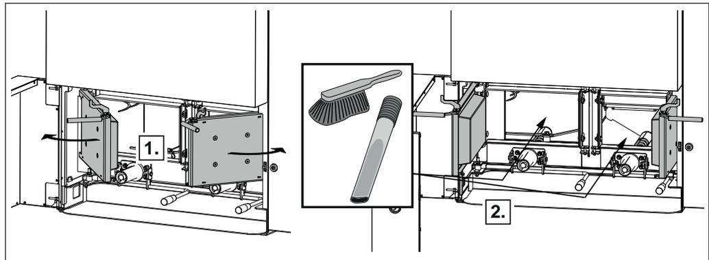
**HINWEIS!** Reinigung von Rost und Brennkammer nur bei ausgekühltem Kessel!
