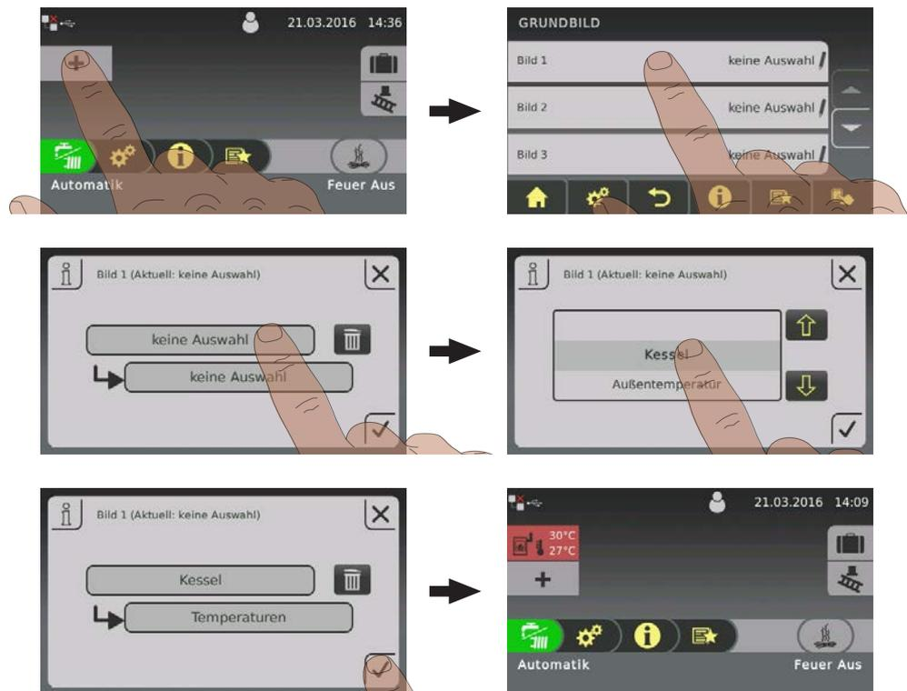
Bei Verwendung von mehr als zwei Pufferfühlern ist eine Informationsanzeige mit Puffertemperaturen gemäß der Anzahl an Fühlern möglich. Die Darstellung erfolgt in einer über zwei Flächen verlaufenden Informationsanzeige.
