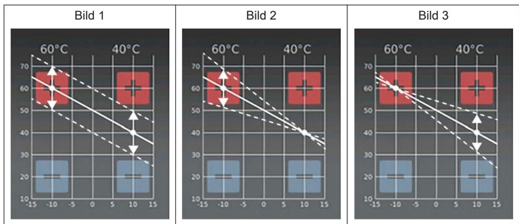
Die Heizkurve kann je nach Situation durch Tippen auf „+“ oder „-“ bei  $\pm 10^{\circ}\text{C}$  Außentemperatur angepasst werden.
