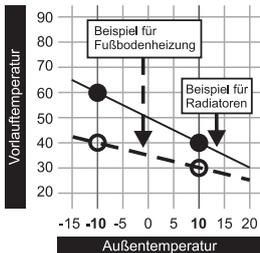
Über die Heizkurve des Heizkreises wird in Abhängigkeit der Außentemperatur mit den zwei einstellbaren Parametern „Vorlauftemperatur bei  $-10^{\circ}\text{C}$  Außentemperatur“ und „Vorlauftemperatur bei  $+10^{\circ}\text{C}$  Außentemperatur“ eine Vorlauftemperatur errechnet.
