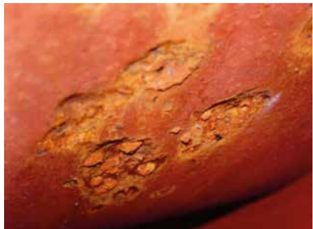
Foto de corrosión cáustica.
