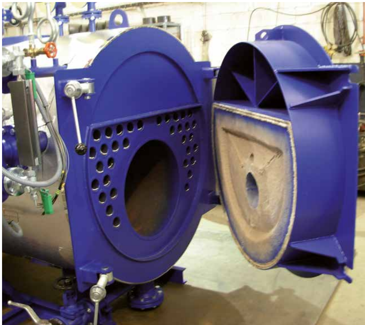
Interior de una caldera HDR
