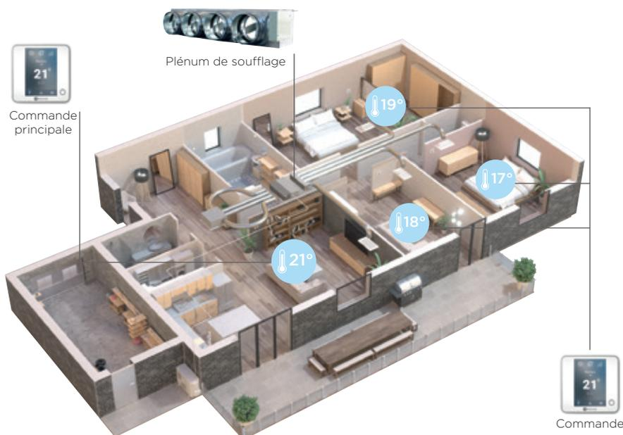
Dans une installation avec zoning, l'unité intérieure est équipée d'un plénum de soufflage AIRZONE ou BAILLINDUSTRIE. Ces plénums sont motorisés et permettent de réguler la température pièce par pièce.
