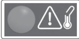
Se la spia di surriscaldamento è accesa, individuare la causa del surriscaldamento e, se necessario, porvi rimedio. Una volta risolto il problema, si dovrà ripristinare manualmente il termostato di sicurezza scattato in seguito al surriscaldamento.
