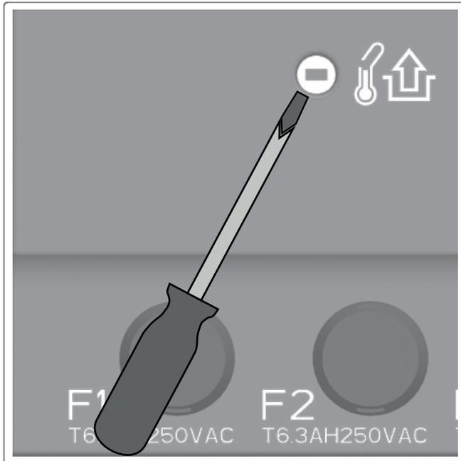
figura 28 - Ripristino del termostato di sicurezza
