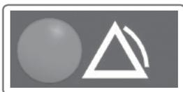
Se la spia di anomalia esterna è accesa, controllare l'apparecchio esterno collegato ai morsetti 3, 4 e 5 del quadro di comando per capire di cosa si tratta, individuarne la causa e rimuoverla. Non è necessario effettuare un ripristino sul quadro di comando.
