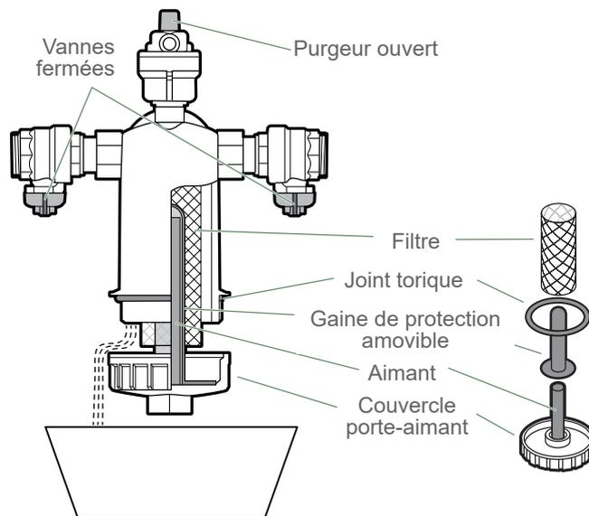
fig. 16 - Nettoyage du pot à boues
