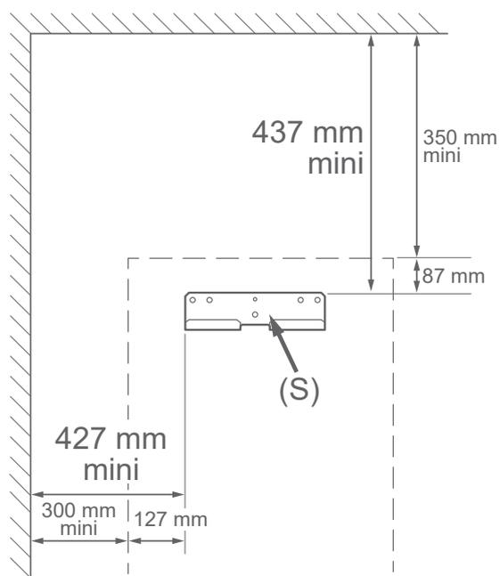
**fig. 8 - Fixation du support**
