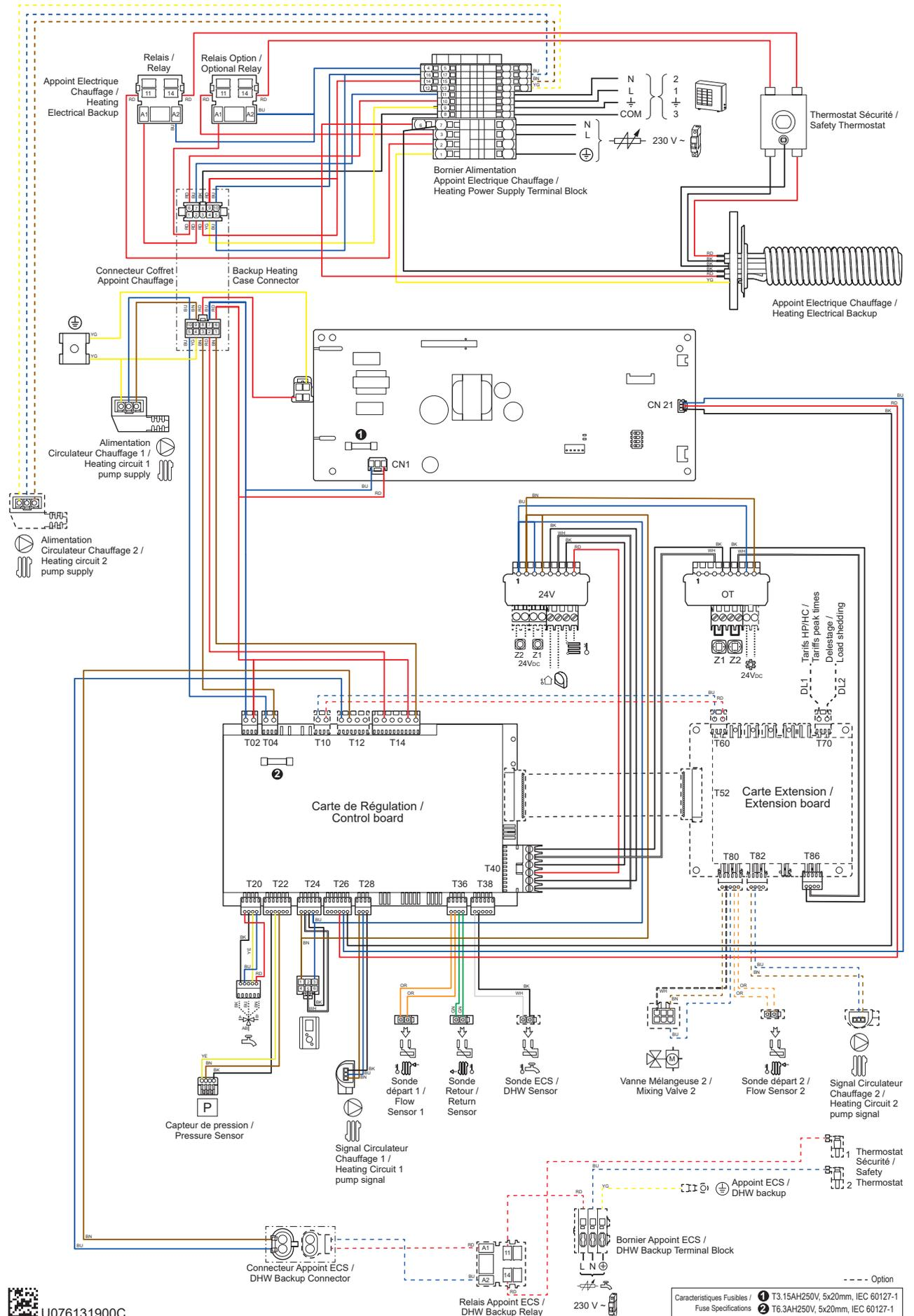
fig. 17 - Câblage électrique Module hydraulique (hors raccordements installateur)
