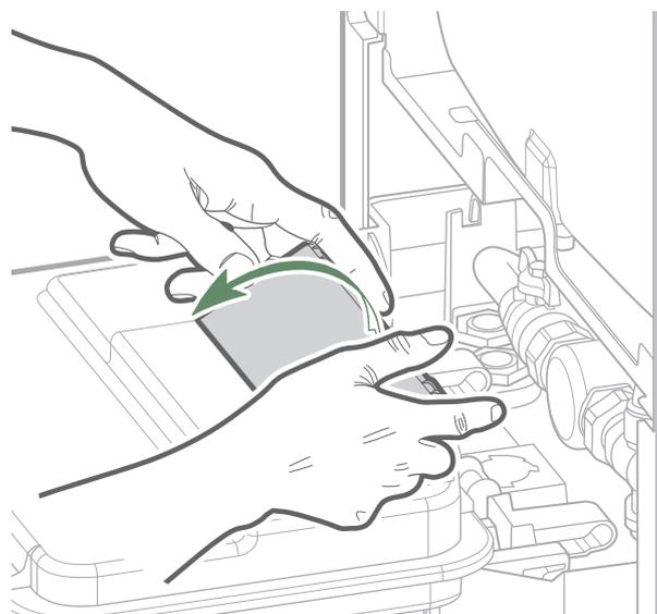
fig. 11 - Accès aux borniers du module hydraulique
