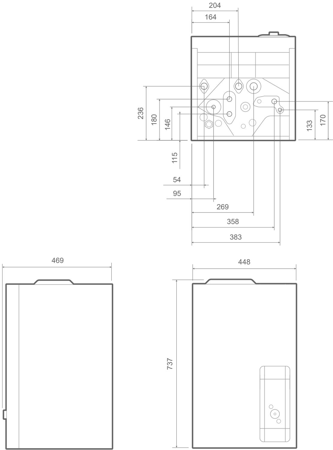
fig. 3 - Dimensions en mm
