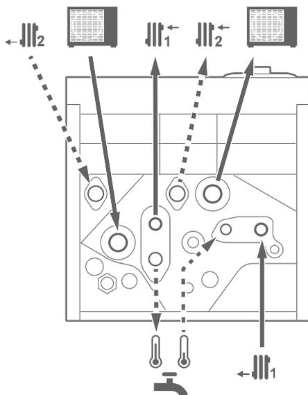
fig. 5 - Raccordements hydrauliques
