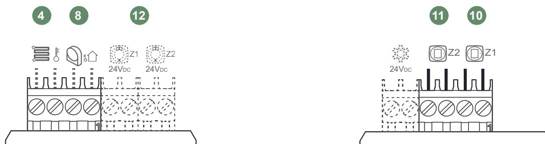
fig. 14 - Raccordements Sondes
