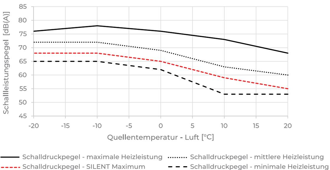
Die Diagramme zeigen die Veränderung der Schallleistung bei vier verschiedenen Heizleistungen in Abhängigkeit von der Aussenlufttemperatur.
