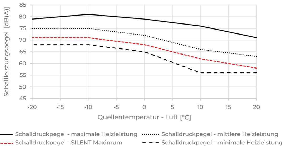
Die Diagramme zeigen die Veränderung der Schalleistung bei vier verschiedenen Heizleistungen in Abhängigkeit von der Aussenlufttemperatur.
