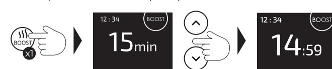
Je peux régler la durée du Boost de 5 minutes à 1 heure. La durée est de 15 minutes par défaut. À la fin du boost, l'appareil revient au mode de fonctionnement précédent.
