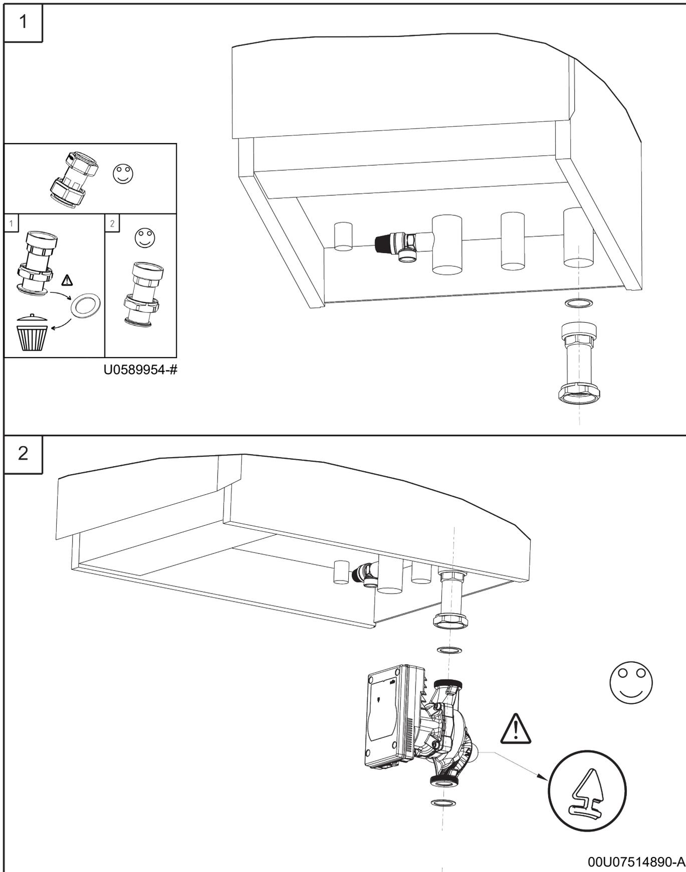
Per il collegamento del circolatore fare riferimento al manuale della caldaia
