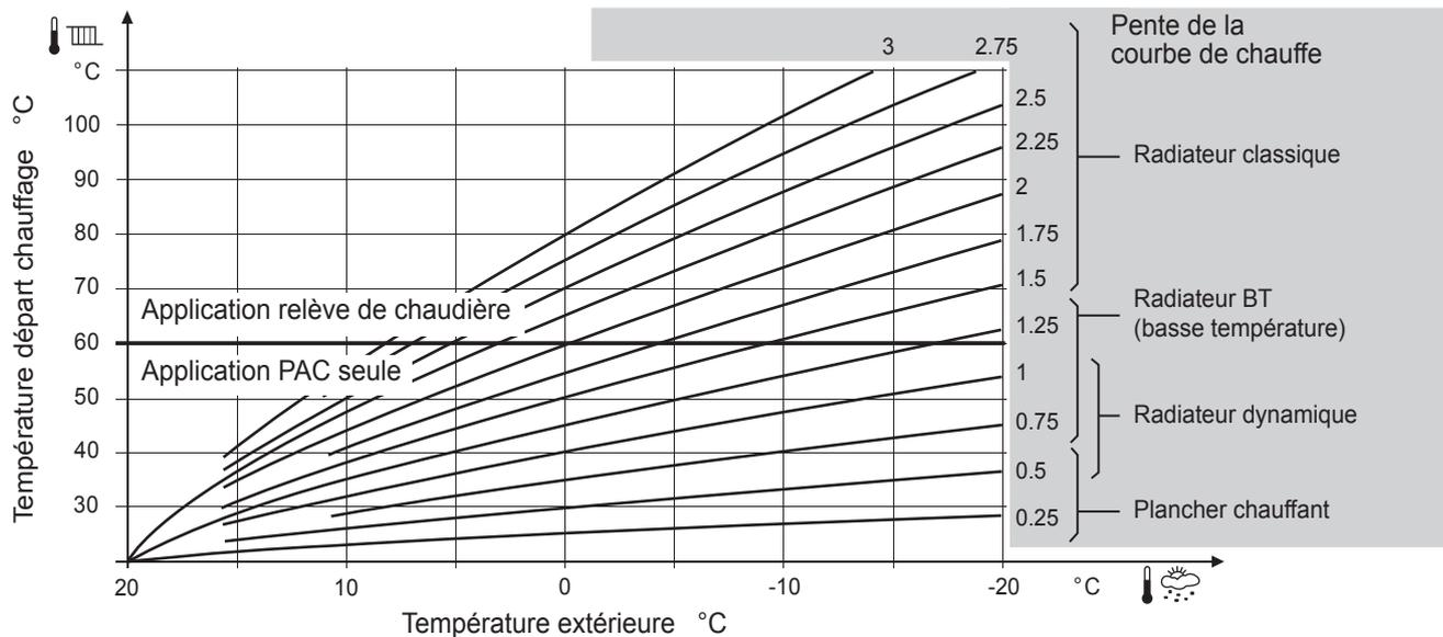
fig. 48 - Pente de la courbe de chauffe
