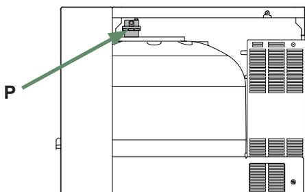
fig. 25 - Purgeur automatique du module hydraulique
