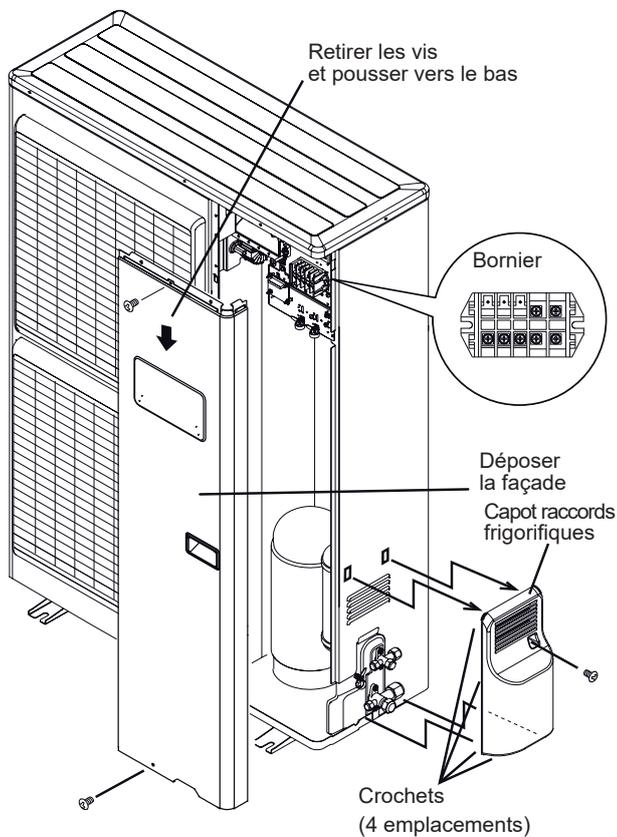
fig. 34 - Accès au bornier de l'unité extérieure monophasée
