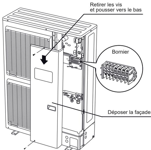
fig. 37 - Accès au bornier de l'unité extérieure triphasée
