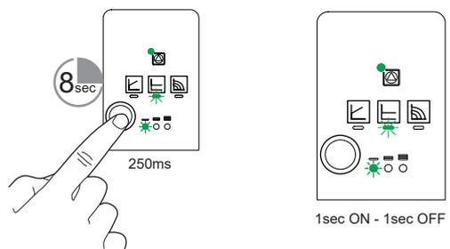
fig. 30 - Verrouillage & déverrouillage des réglages du circulateur
