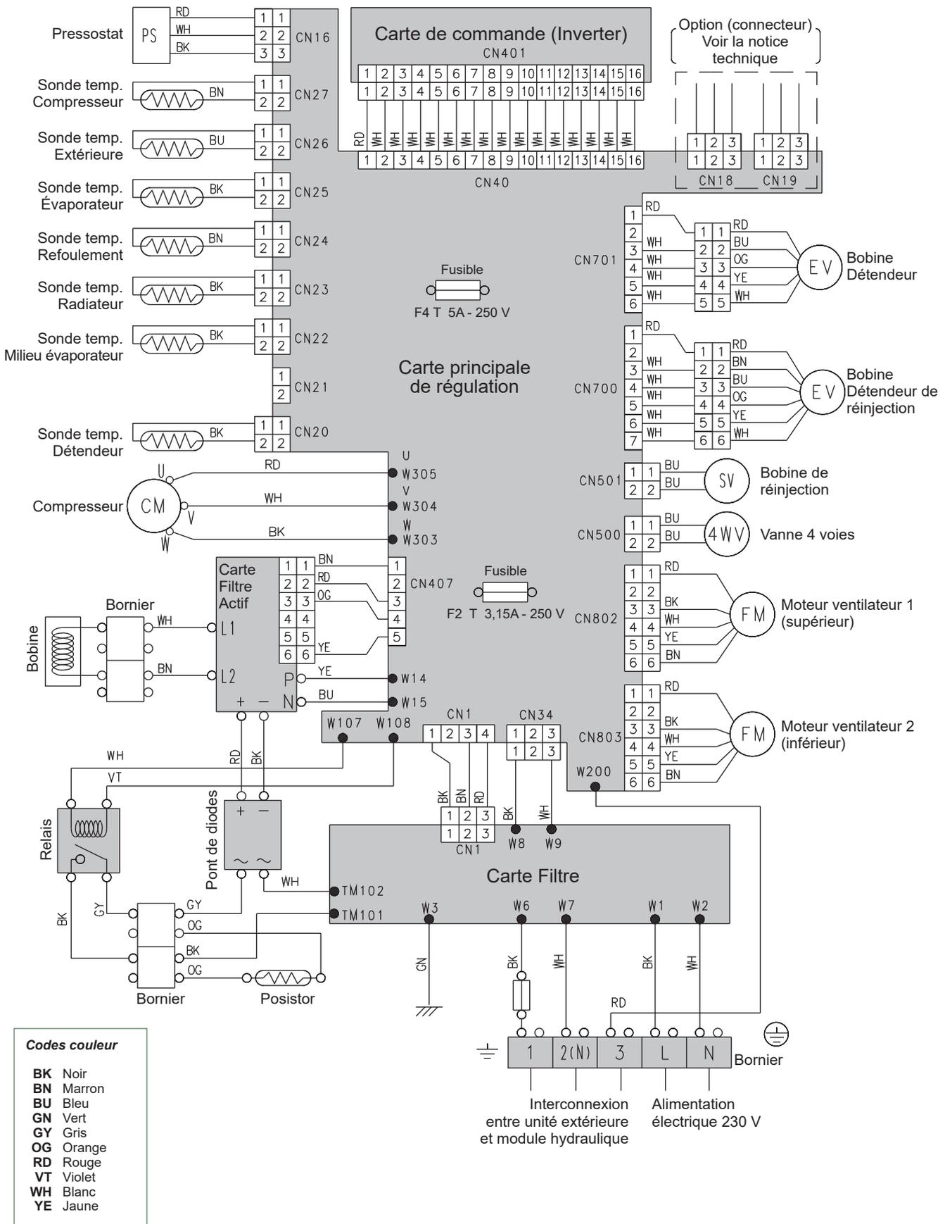
fig. 51 - Câblage électrique unité extérieure modèles monophasées
