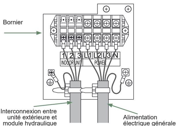
fig. 38 - Connexions au bornier de l'unité extérieure triphasée
