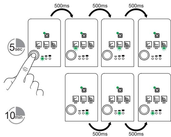
fig. 29 - Redémarrage manuel du circulateur
