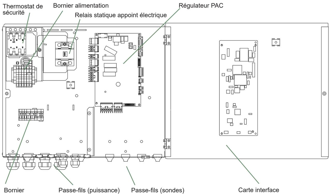
fig. 42 - Descriptif du coffret électrique du module hydraulique triphasé
