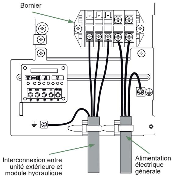
fig. 35 - Connexions au bornier de l'unité extérieure monophasée
