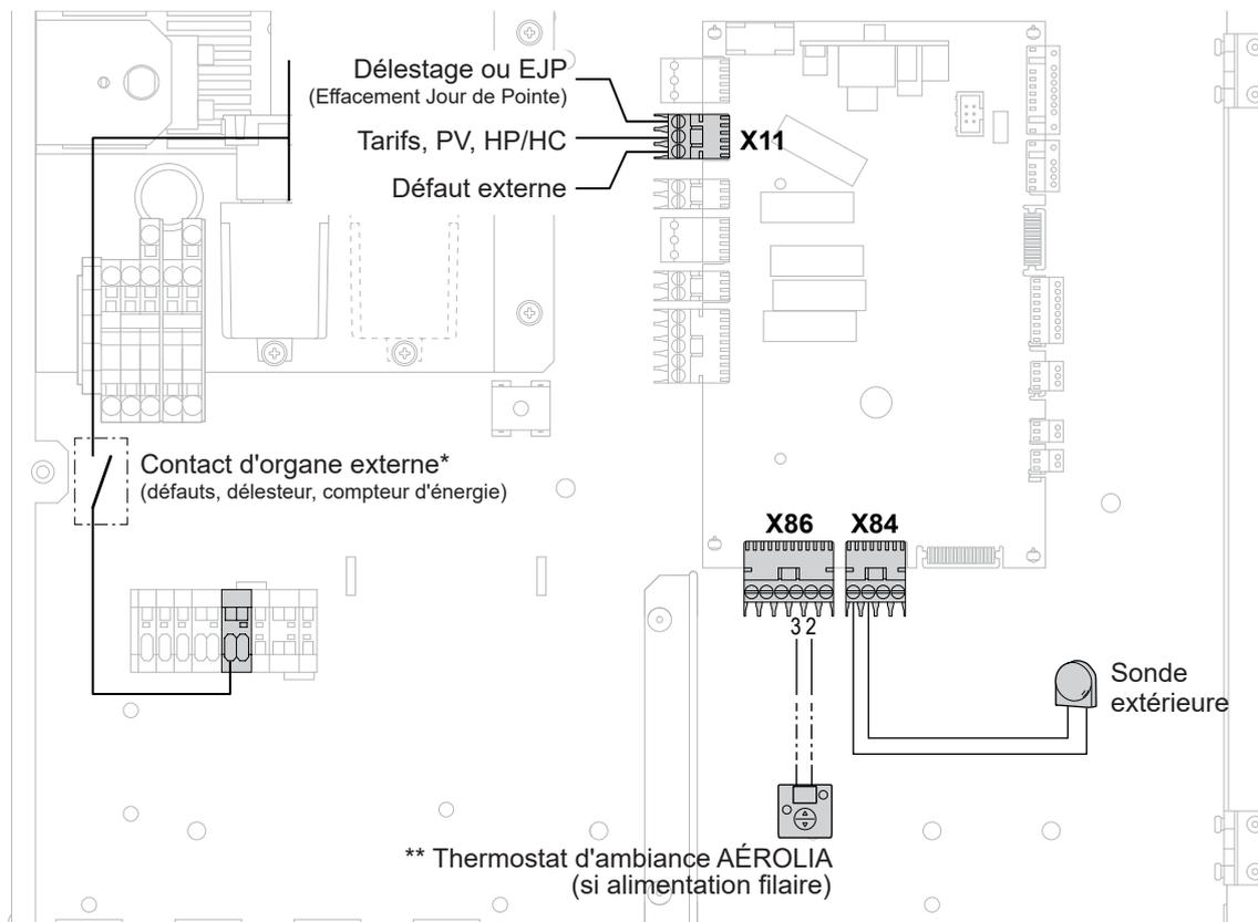
\* Si l'organe de commande ne délivre pas de contact libre de potentiel, il faudra relayer le contact pour obtenir un câblage équivalent. Dans tous les cas, se reporter aux notices des organes externes (délesteur, compteur d'énergie...) pour réaliser le câblage.
