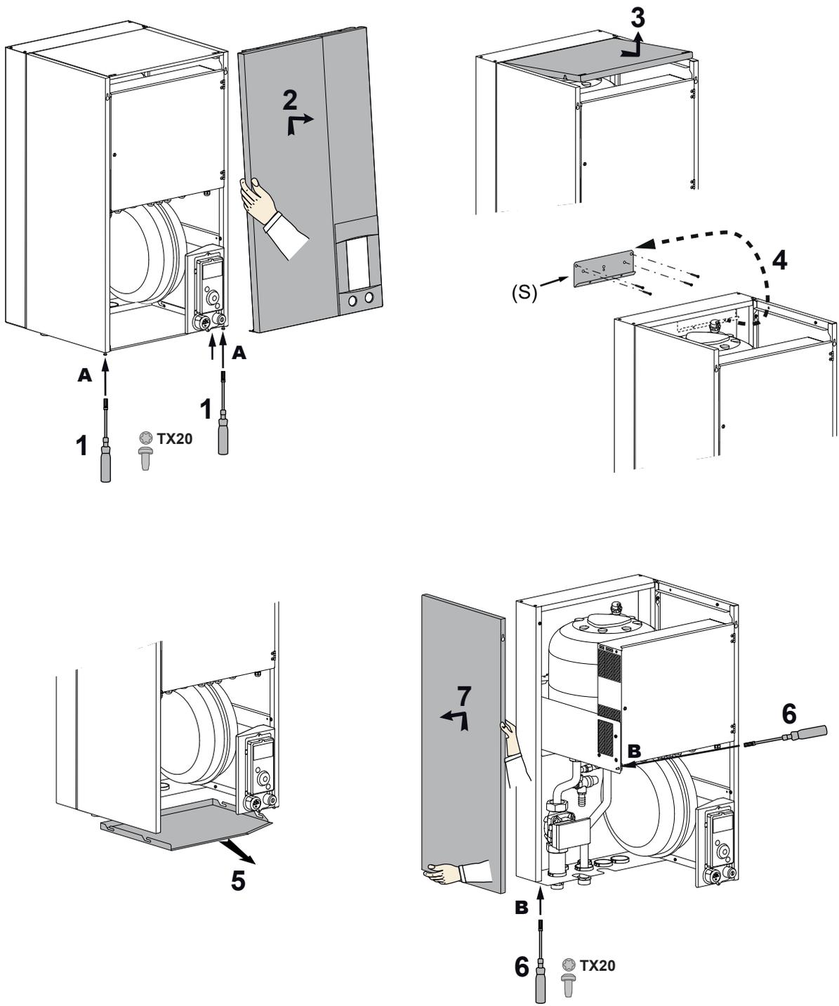
fig. 16 - Dépose de l'habillage
