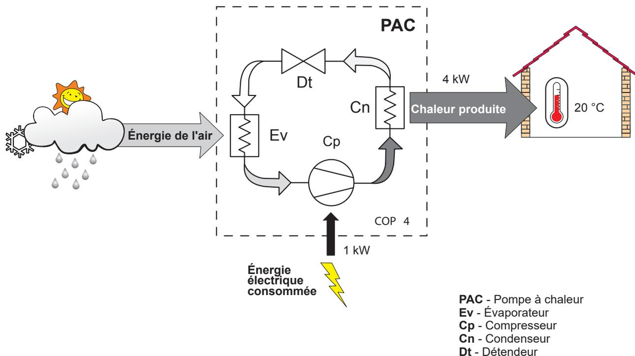
fig. 11 - Principe de fonctionnement d'une pompe à chaleur
