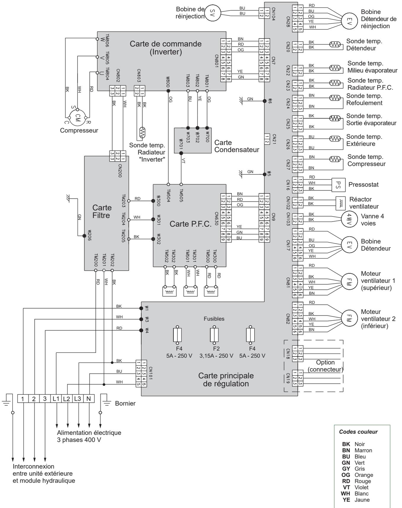
fig. 52 - Câblage électrique unité extérieure modèles triphasées
