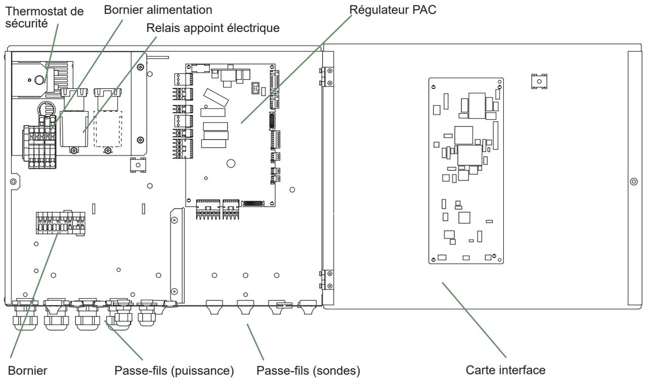
fig. 43 - Descriptif du coffret électrique du module hydraulique monophasé
