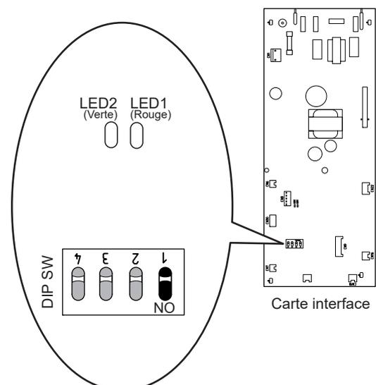
fig. 24 - Emplacement des interrupteurs DIP et des LED sur la carte d'interface du module hydraulique
