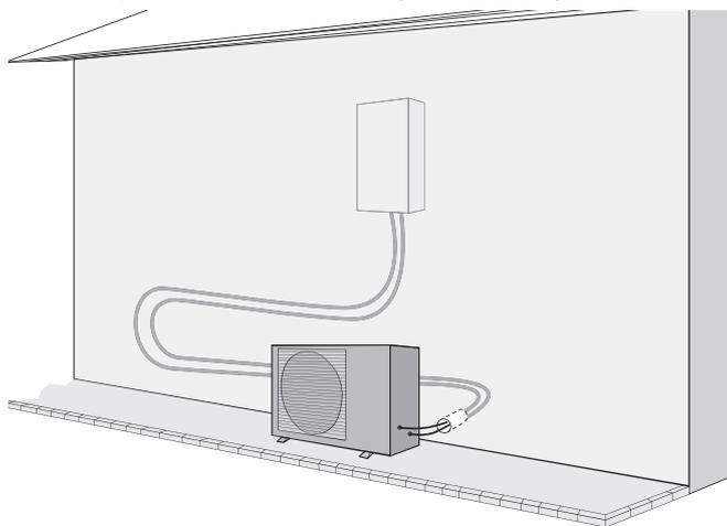
*fig. 12 - Exemple conseillé de disposition des liaisons frigorifiques*
