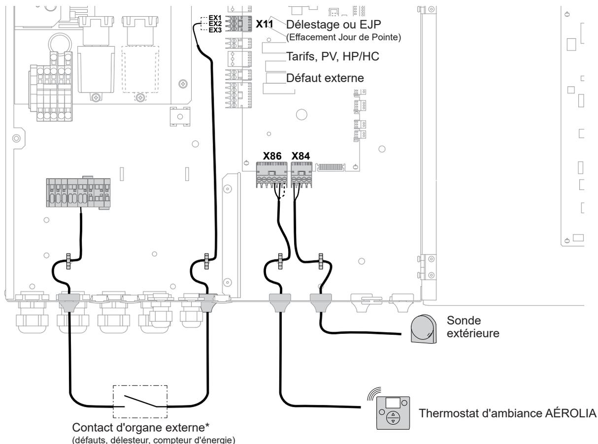
fig. 45 - Passage des câbles des sondes
