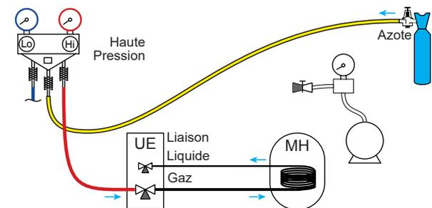
c) Raccorder à nouveau le flexible sur la pompe à vide, la mettre en fonction et ouvrir progressivement la vanne du flexible.
