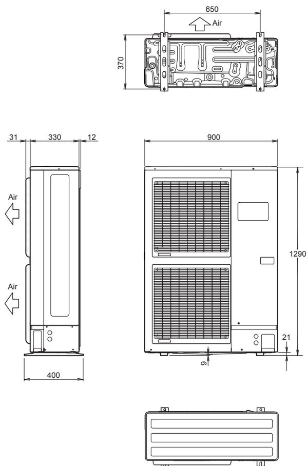
fig. 1 - Dimensions en mm
