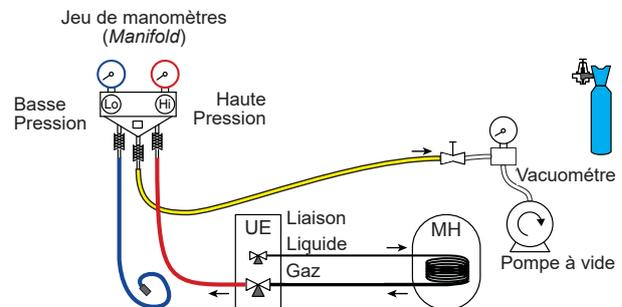
b) Couper la pompe à vide, fermer la vanne en bout du flexible de service (jaune), raccorder ce flexible sur le détendeur de la bouteille d'azote, injecter 2 bars, refermer la vanne du flexible,
