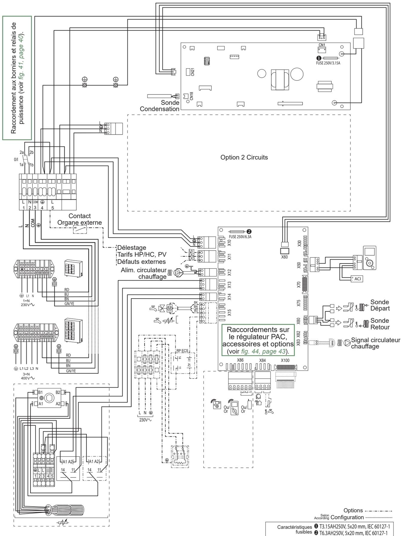
fig. 53 - Câblage électrique module hydraulique monophasé (hors raccordements installateur)
