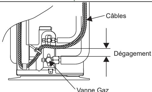
fig. 36 - Finalisation de la connexion de l'unité extérieure monophasée
