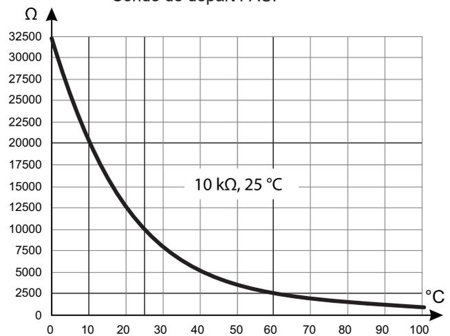
fig. 5 - Valeur ohmique des sondes (Module hydraulique)
