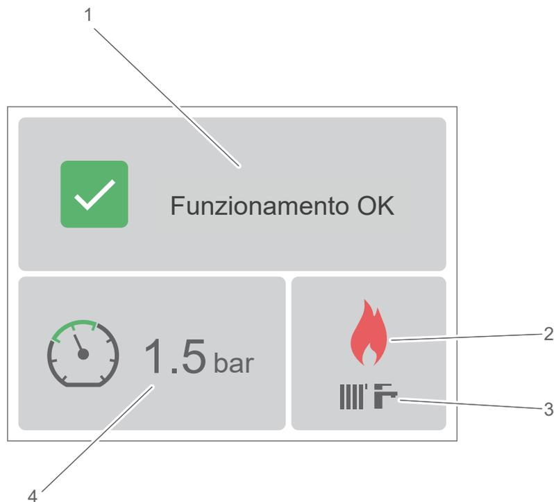
**1 - Stato** della caldaia: Funzionamento OK, Errore, Calibrazione in corso, Riempimento in corso, Spurgo aria in corso, Modalità test in corso, Non calibrata
