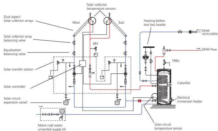
**Scheme C Trigon solar medium-volume DHW system**
