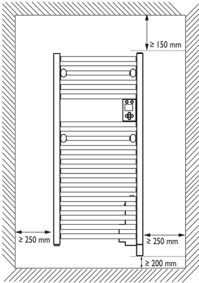
Le boîtier de puissance en bas de votre appareil doit être au minimum à 5 mm de distance de votre mur pour assurer une bonne aération.
