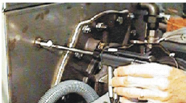
4. Insérez la sonde horizontalement dans la chambre de combustion jusqu'au marquage.
