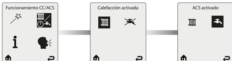
La función **Funcionamiento CC/ACS** permite simplemente activar o desactivar los servicios de Calefacción y de ACS de la caldera.
