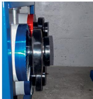
Présenter le prochain module à côté du module pour le réglage et la mise à niveau. Utiliser un niveau à bulle et une clé N°17 pour le réglage des pieds.
