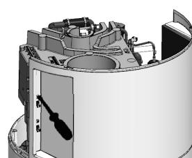
6 Desserrer le serre-câble sur le capot arrière pour y passer le câble (non fourni) des équipements optionnels.
