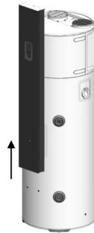
2 Soulever la colonne pour la décrocher des inserts en bas en faisant attention au câble de l'écran commande et au câble de terre.
