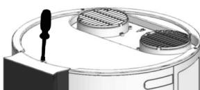
1 Retirer la vis de verrouillage de la colonne.
