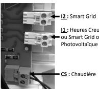
**8** Visser le câble sur le connecteur associé en fonction de l'équipement raccordé.
