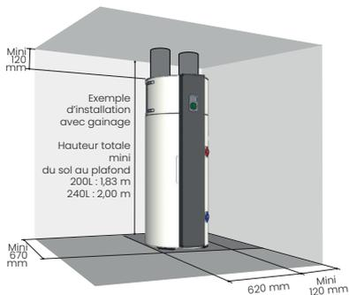
Il est impératif d'utiliser des gaines de Ø 160 mm, des gaines d'air isolées et des gaines rigides ou semi-rigides.
