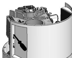
❻ Desserrer le serre-câble sur le capot arrière pour y passer le câble (non fourni) des équipements optionnels.
