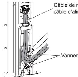
Acheminez le câble de raccordement et le câble d'alimentation à l'arrière de l'unité extérieure entre les 2 vannes comme indiqué dans la figure. (Pour faciliter l'installation du couvercle de commutateur.)
