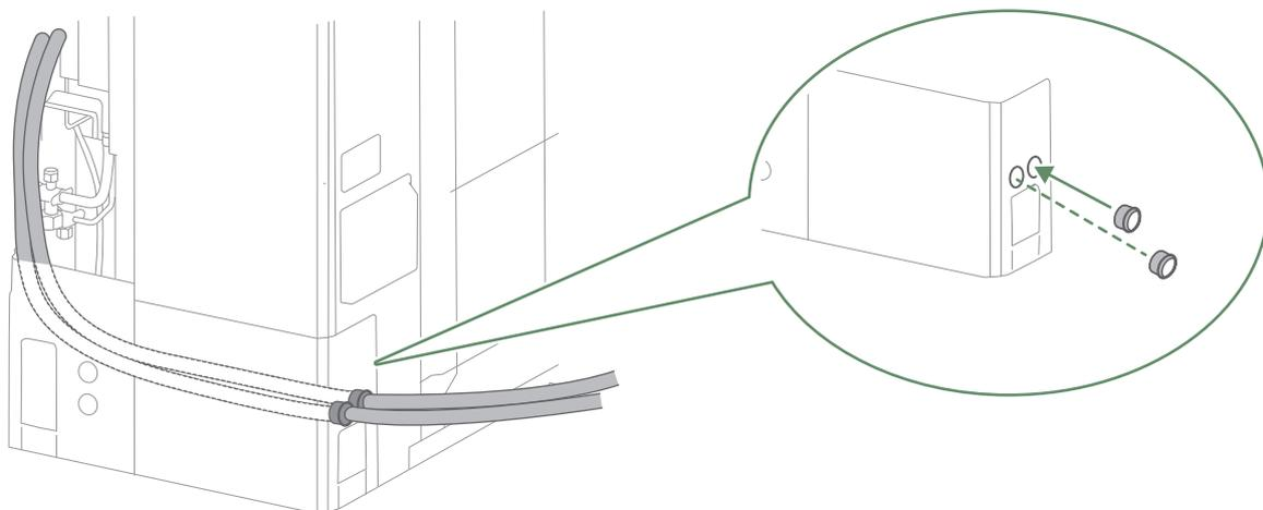
fig. 39 - Passage des câbles et installation des bagues à 1 contact
