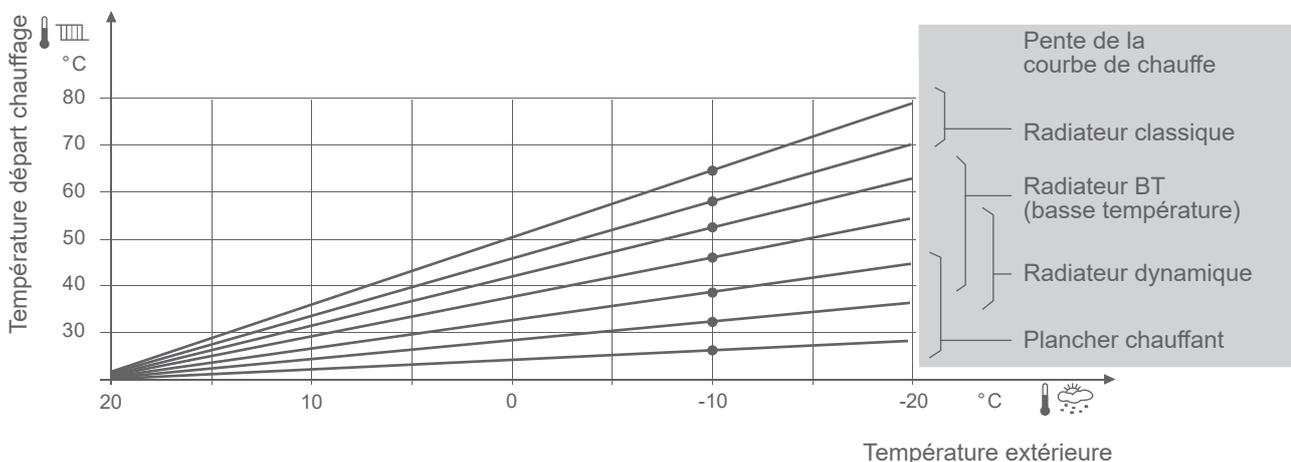
fig. 42 - Pente de la courbe de chauffe
