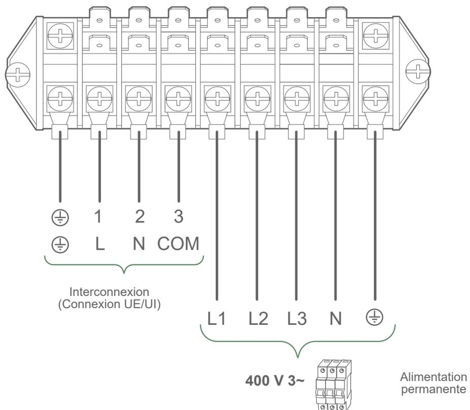
fig. 40 - Borniers de raccordement électrique coté unité extérieure
