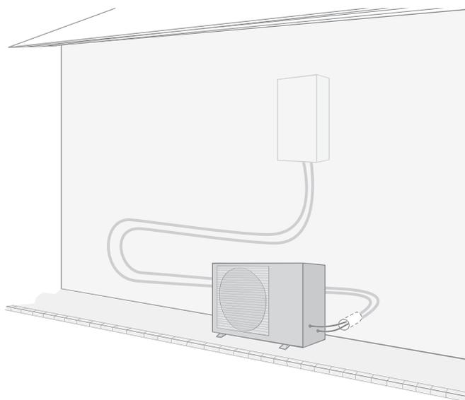
*fig. 12 - Exemple conseillé de disposition des liaisons frigorifiques*
