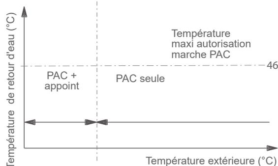
fig. 10 - Exemple et limites de fonctionnement
