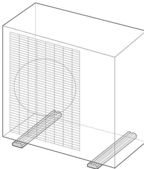
fig. 17 - Disposition de pieds en caoutchouc (option)
