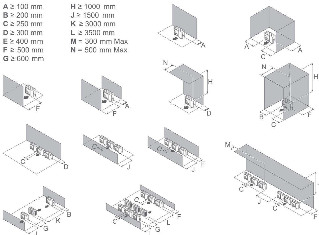
fig. 14 - Dégagements minimum d'installation autour de l'unité extérieure
