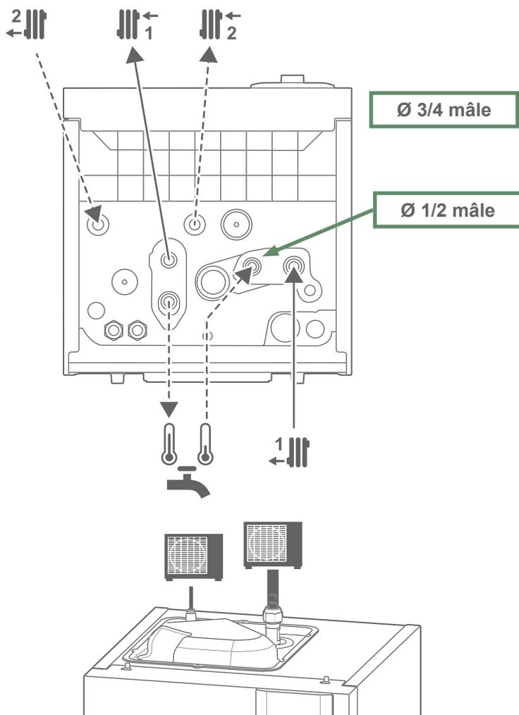
fig. 2 - Repérage hydraulique
