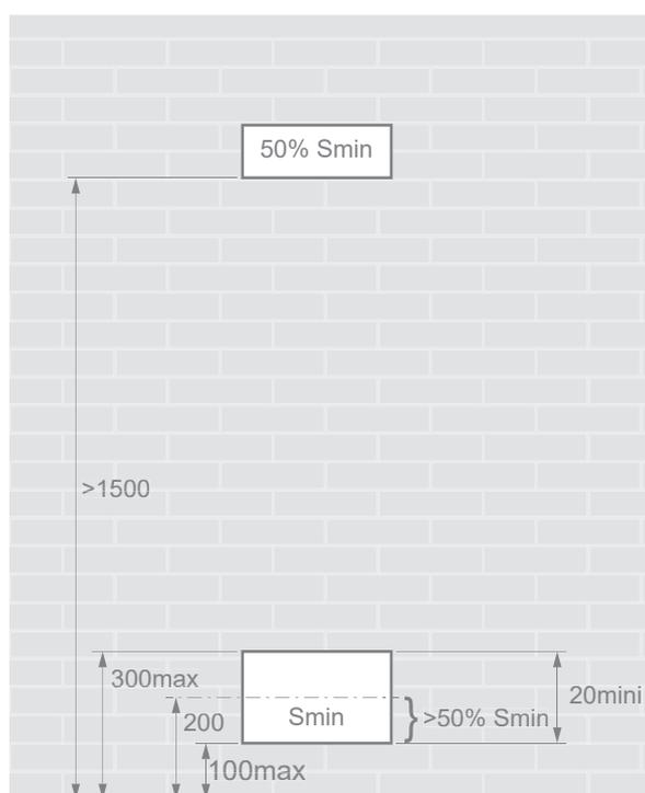
fig. 25 - Position des ouvertures pour la ventilation
