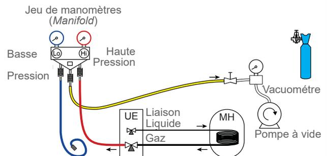
b) Couper la pompe à vide, fermer la vanne en bout du flexible de service (jaune), raccorder ce flexible sur le détendeur de la bouteille d'azote, injecter 2 bars, refermer la vanne du flexible,
