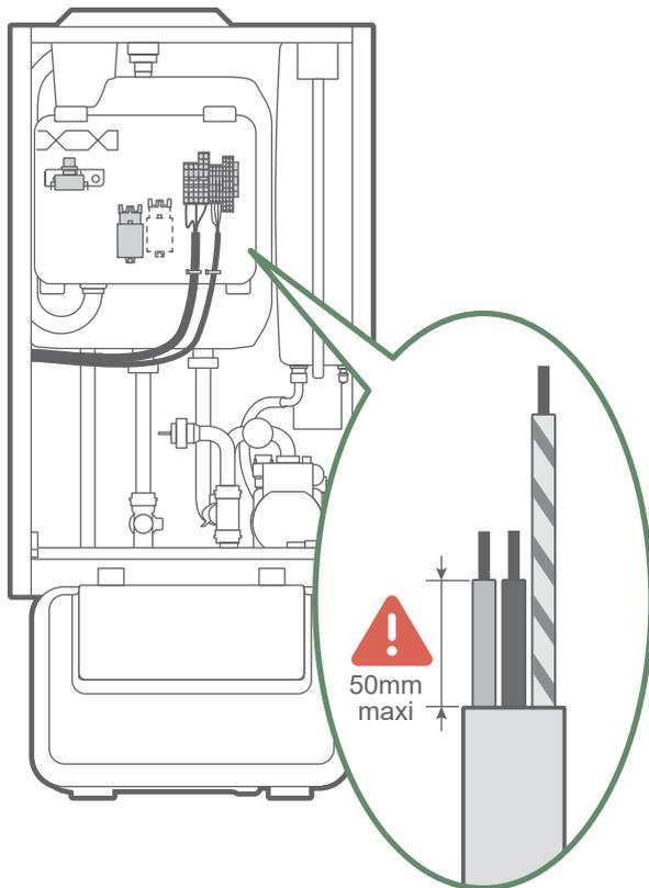
■ **Bornier coffret appoint électrique chauffage**
