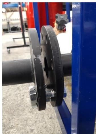
Coloque la válvula, prestando atención a la dirección de flujo del fluido indicado en el cuerpo mediante una flecha. Debe apuntar hacia la caldera.
