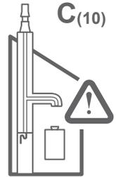
Incollare le due etichette con le informazioni C(10) sul condotto di fumisteria e sulla caldaia.
