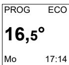
Wenn auf dem Bildschirm ECO PROG angezeigt wird, befinden Sie sich in einem Programmierbereich im ECO-Modus.
