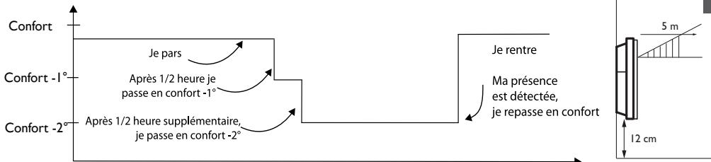
⚠ La détection ne se fait pas en dessous du capteur.
