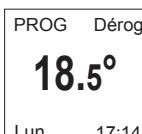
Vous pouvez modifier la température ECO, vous forcez donc le réglage par défaut entre la température Confort et la température Eco. «PROG Dérogi» s'affiche jusqu'à la prochaine plage Confort. Vous pouvez régler l'écart entre la température Confort et Eco dans le menu «Abais. T° ECO» (voir chapitre «Le menu en mode PROG»).
