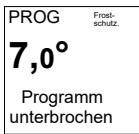
Wenn Sie eine Frostschutztemperatur (7°C) einstellen, wird die Programmierung ausgesetzt.
