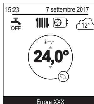
In caso di errore proveniente dall'unità esterna, l'unità di comando visualizza il codice d'errore "370: Sorgente termodinamica" seguito dall'errore dell'unità esterna.
